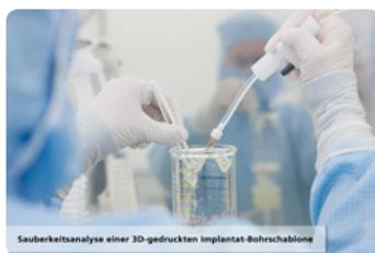
Saubereitsanalyse einer 3D-gedruckten Implantat-Bohrschablone
