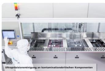
Ultraschallreinigung an kontaminationskritischen Komponenten
