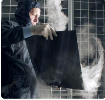
Durch die in der Body Box variabel einstellbare Strömungsgeschwindigkeit werden die strömungstechnischen Auswirkungen der beiden Strömungsarten gezeigt. Dabei werden die Aktionen live aus der Body Box kommentiert und die Auswirkungen in Form von Nebel visualisiert und die Unterschiede und Auswirkungen mit dem Partikelzähler gezeigt. Entsprechende Um- und Anströmungen von Objekten runden die Demo ab.
