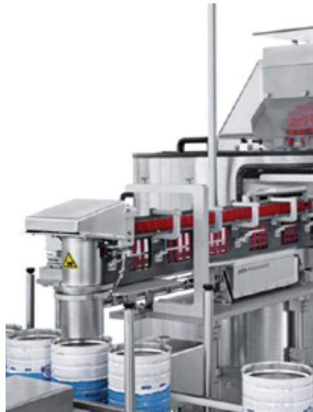
Das schweizerische Unternehmen Swiss Can Machinery hat seit Kurzem den weltweit ersten Löffelspender für Dosen mit einer UVC-Desinfektionsrate von mehr als 99,99 Prozent im Einsatz. (Quelle: Swiss Can Machinery, sterilAir AG)
