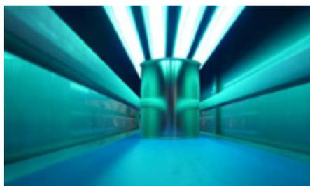
Im Leerdosenentkeimer, der zusätzlich mit einem Deckelförderband LT 127 ausgestattet ist, sind acht UVC-Röhren mit individueller Überwachung eingebaut. Mithilfe der UVC-Strahlung wird die DNA der Zellen deaktiviert, was die mikrobiologischen Werte und die geforderte Hygiene sicherstellt. (Quelle: Swiss Can Machinery, sterilAir AG)
