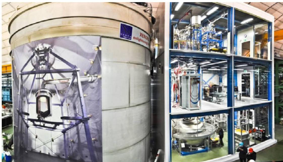
XENONIT in Halle B des LNGS: rechts das Gebäude, eine Stahlkonstruktion mit gläsernen Wänden, das die Xenon-Aufbereitung sowie die Experimentsteuerung und Datenerfassung beherbergt, links der große Wassertank, in dessen Mitte der Detektor installiert ist. (© XENON Collaboration)
