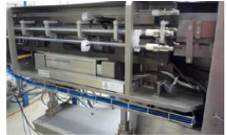
Der Löffelspender SD 153 ist mit einem Dosenförderband aus rostfreiem Stahl ausgestattet. Die Löffelzuführung aus Chromstahl erfolgt mittels eines Linearförderers, der Wendelfördertopf enthält einen zusätzlichen Vibrationsbunker mit einem Füllvolumen von 100 Litern. (Quelle: sterilAir AG)
