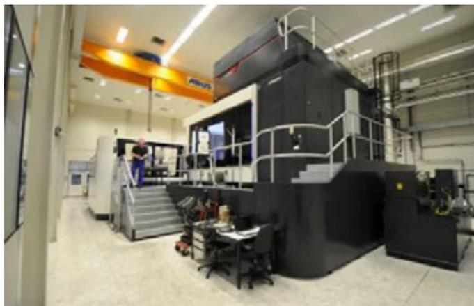
Um die Unterteile von Bogendruckmaschinen im Werk Würzburg mit einem hochfeinen Finish zu versehen, schaffte KBA 2015 ein DIXI 270-Bearbeitungszentrum des Schweizer Herstellers DMG Mori an. (Quelle: Nerling Systemräume GmbH)
