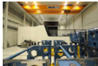
Die Raumanlage besteht aus einer Stahlkonstruktion, die als Tragwerk für die Decke und den bauseitigen 12,5 t-Kran dient. (Quelle: Nerling Systemräume GmbH)
