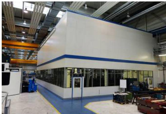
Damit die Maschine die erforderlichen Genauigkeitswerte von ffl 10 µm einhalten kann, muss im Maschinenraum eine Temperatur von 22 °C ffl 0,2 K/h eingehalten werden. Um diese klimatischen Bedingungen zu gewährleisten, ließ KBA von der Nerling Systemräume GmbH einen Präzisionsfertigungsraum mit Vortemperiererraum einrichten. (Quelle: Nerling Systemräume GmbH)
