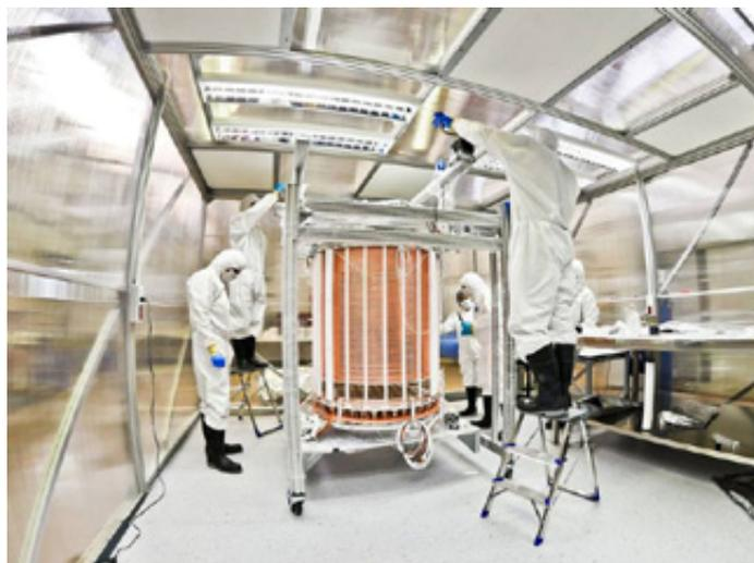
Montage des XENONnT-Detektors im Reinraum. (© XENON Collaboration)
