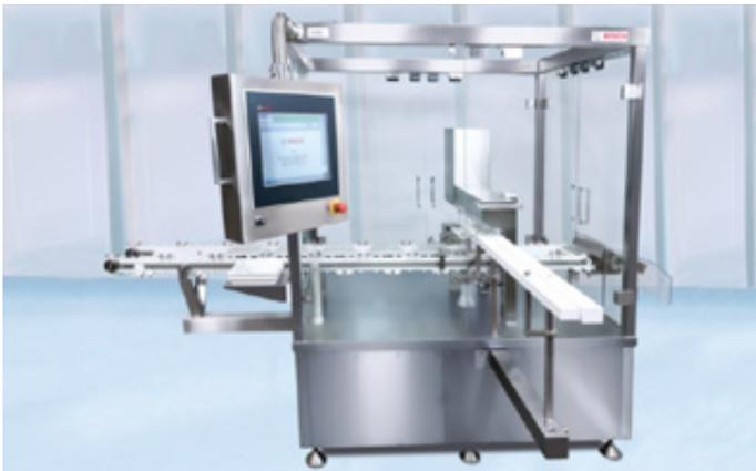
USD Denester für vorsterilisierte Spritzen: Der USD Denester erzielt je nach Modell eine Ausbringung von 400 Spritzen pro Minute. Mit dem passenden Fill-Finish- und Inspektionsequipment sowie einem ZPS Puffersystem und einer RIL Kolbenstangenmontage- und Etikettiermaschine lässt der Denester sich zu einer kompletten Spritzenlinie kombinieren.
