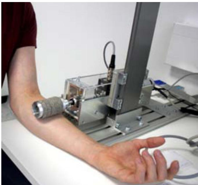
Mit Hilfe des elektromechanischen Textilapplikators SOFIA 2 können Textilien standardisiert an verschiedenen Körperstellen mit unterschiedlichem Druck und Geschwindigkeit auf der Haut aufgebracht werden. Zugleich wird der Reibungskoeffizient bestimmt. (© Hohenstein Institute)
