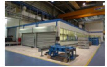
Insgesamt entstand so eine U-förmige Systemraumanlage aus dem Klimaraum (rechts im Hintergrund), dessen Vortemperierbereich (Bildmitte), dem Messraum sowie dessen Vortemperierbereich (links im Hintergrund). (Quelle: Nerling Systemräume GmbH)
