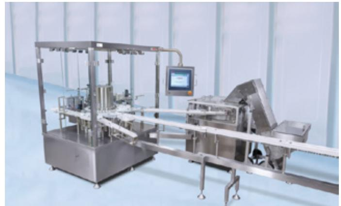
RIL Kolbenstangenmontage- und Etikettiermaschine: Die Hochgeschwindigkeitsmaschinen der RIL-Baureihe übernehmen die exakte und schonende Kolbenstangenmontage und sorgen für eine zuverlässige Etikettierung der Spritzen.
