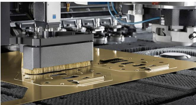
In vielen Fällen nutzt LK Mechanik auch das kombinierte Laser-Stanzen zur Fertigung der Komponenten für seine Werkstückträger-Systeme. (Bild: LK Mechanik)
