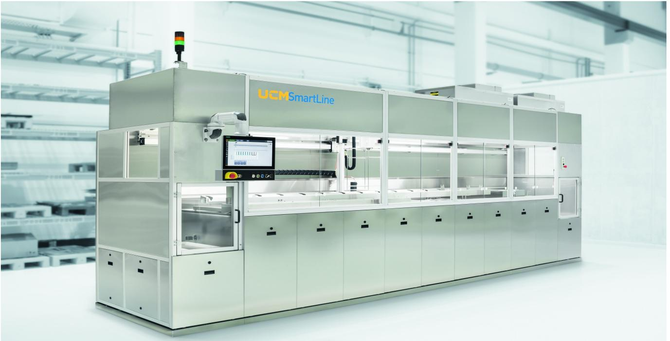
Das modulare Konzept der UCMSmartLine ermöglicht den individuellen Aufbau von Ultraschall-Reihentauchanlage für eine breites Anwendungsspektrum. In jedes Modul ist die Elektro- und Steuerungstechnik integriert.
