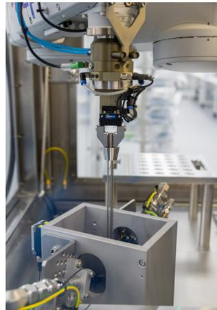
Das als Schleuse zum Reinraum ausgeführte CO<sub>2</sub>-Schneestrahlsystem kommt für die Reinigung von Stents aus Nitinol zum Einsatz. (Bildquelle: acp systems)
