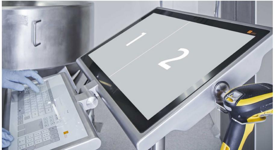
Abbildung 2: Single-Display-Lösung mit WAVE 227 mit UHD-Auflösung zur Anzeige von zwei Softwaresystemen in einem Bildschirm. (Bildrechte: Systec & Solutions GmbH)
