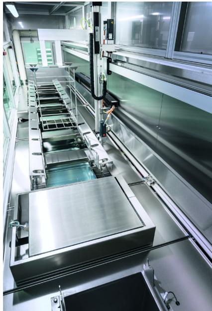
Die Anlagen können mit bis zu neun Reinigungs- und Spülstufen und variabel mit Mono-, Dual- und Multifrequenz-Ultraschall ausgestattet werden.
