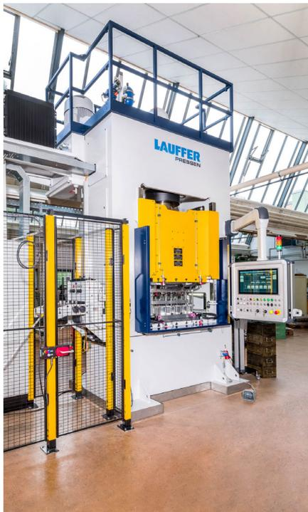
Mit 2000 kN Presskraft, einem Ziehkissen mit gesteuerter Gegenhaltekräften und einem steuerbaren Umformverlauf lassen sich komplexe Umformungen in hoher Teilequalität fertigen. (© Bildquelle: Nägeli Swiss AG)
