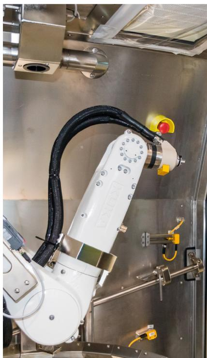
Durch aus elektropoliertem Edelstahl gefertigte Innenwände verfügen die Anlagen über sehr glatte und gut zu reinigende Oberflächen. (Bildquelle: acp systems AG)
