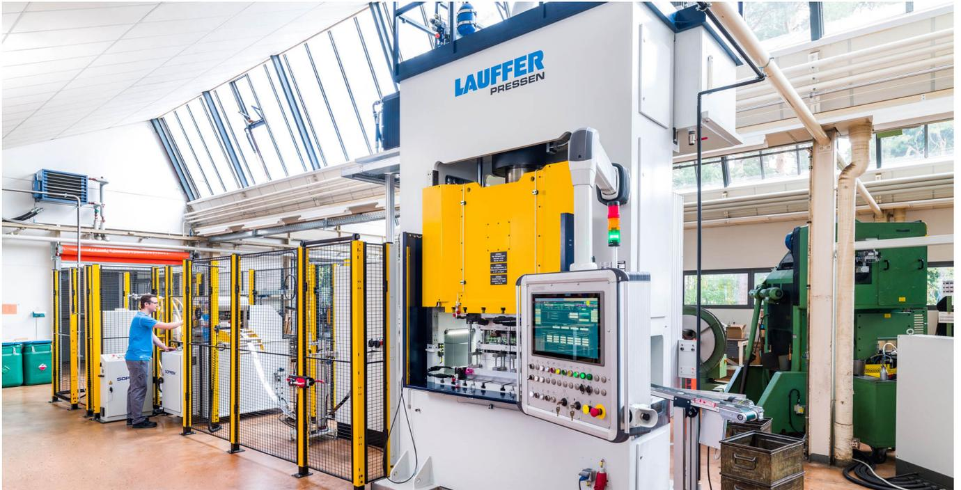
Nägeli Swiss AG tätigt die größte Maschineninvestition der Firmengeschichte und nimmt eine hydraulische 200-Tonnen Presse für die Fertigung von Tiefziehteilen in Betrieb. (© Bildquelle: Nägeli Swiss AG)
