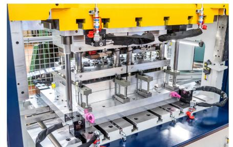
Durch den großen Werkzeugraum sind Ziehhöhen bis 150 mm möglich. (© Bildquelle: Nägeli Swiss AG)
