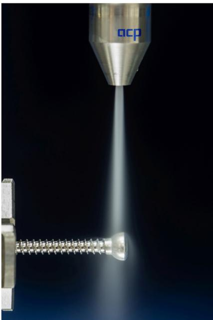
Das in verkettete Produktionsumgebungen integrierbare quattroClean-System ermöglicht die partielle oder ganzflächige Abreinigung partikulärer und filmischer Kontaminationen von praktisch allen technischen Werkstoffen in reinen Umgebungen. (Bildquelle: acp systems AG)
