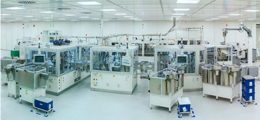
Montageanlage für die Gehäusebaugruppe des wiederverwendbaren Respimat®.
