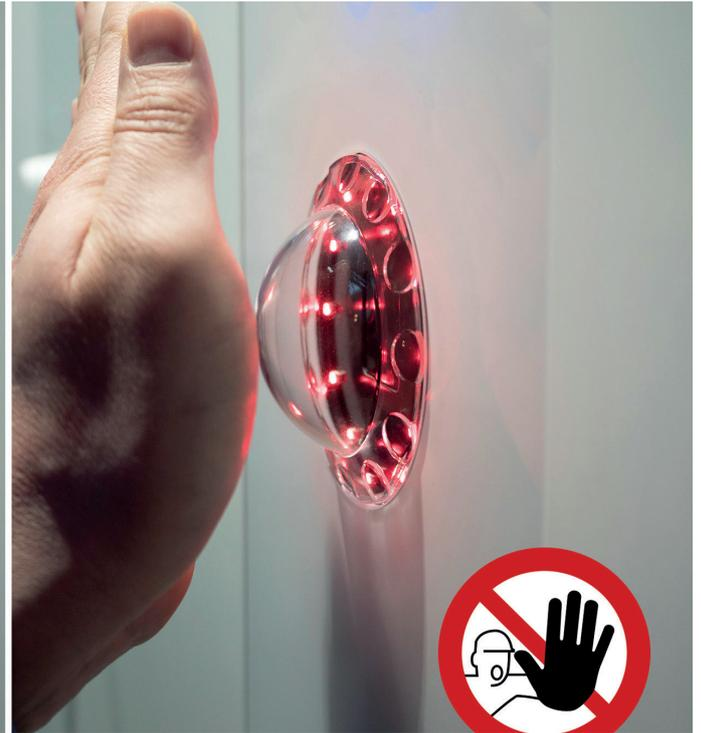
Die in Glasterminals integrierten Handvenenscanner eignen sich durch das biometrische Verfahren als manipulationssichere Zutrittslösung für zahlreiche Anwendungsgebiete.
