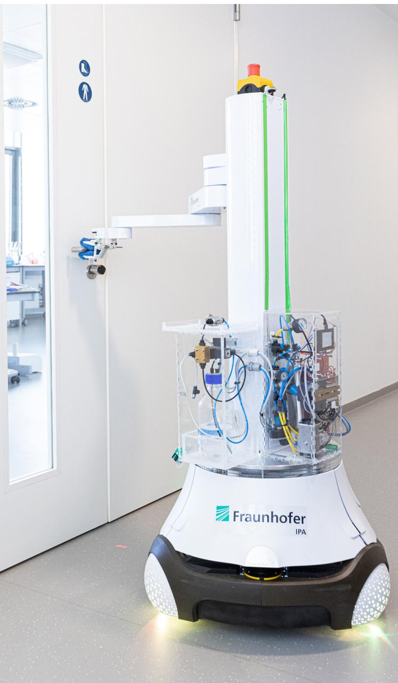
Der mobile Reinigungs- und Desinfektionsroboter DeKonBot fährt selbstständig zu kritischen Objekten wie Türgriffen und desinfiziert diese. (© Fraunhofer IPA, Rainer Bez)
