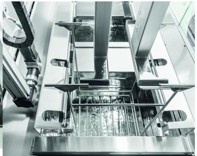
Der serienmäßige Transportautomat verfügt über einen Servoantrieb für einen sehr schonenden Werkstücktransport und teilespezifischen Lift-Out zur Vortrocknung aus dem letzten Spülbecken.
