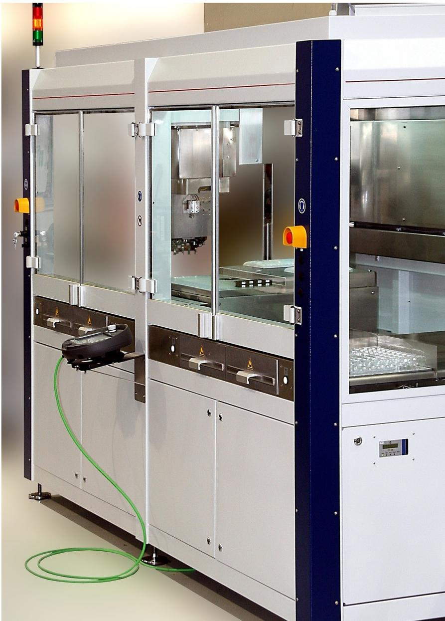
Für die Reinigung von Sensoren wurde der CO<sub>2</sub>-Schneestrahlsprozess in ein Standardmodul integriert. Es ist mit einer Reinluftversorgung sowie einer Medienaufbereitung für das flüssige Kohlendioxid und die Druckluft ausgestattet. (Bildquelle: acp systems AG)
