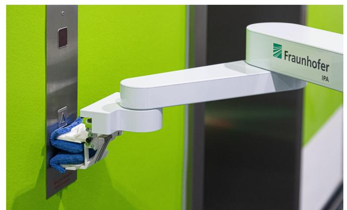
Mithilfe seines flexiblen Reinigungswerkzeug kann DeKonBot eine Wischdesinfektion unterschiedlicher Objekte, bspw. auch Aufzugknöpfe, durchführen. (© Fraunhofer IPA, Rainer Bez)
