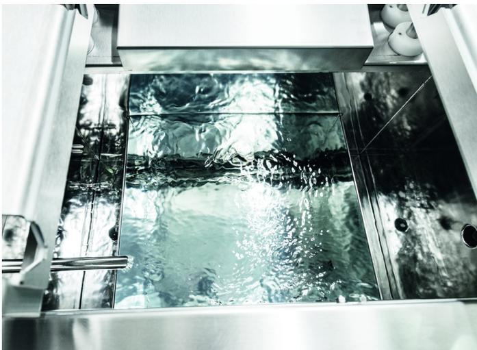
Alle Wannen für Nassstufen der komplett aus elektropoliertem Edelstahl gefertigten Anlage verfügen über einen Zweiseitenüberlauf, durch den abgereinigte Partikel und andere Verschmutzungen sofort ausgetragen werden. Dies minimiert das Rückkontaminationsrisiko beim Umsetzen der Teile.
