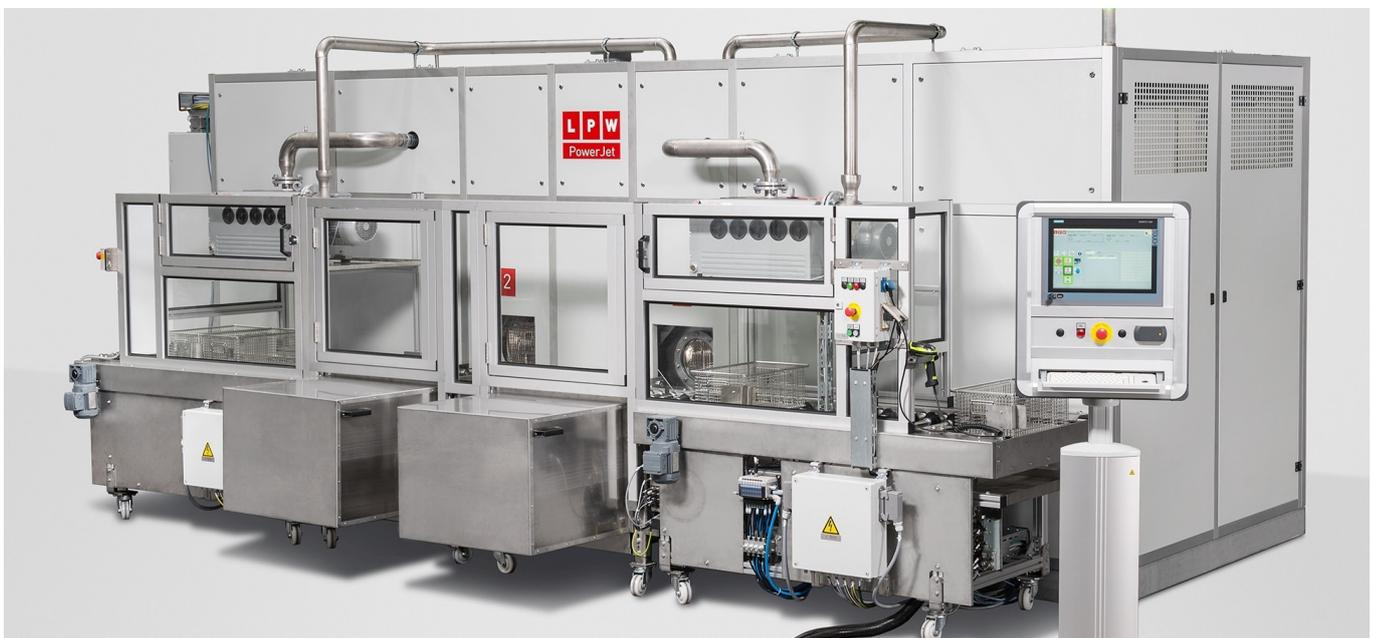
Die Ausführung der Arbeitskammer und Verrohrung sollte bei Reinigungsaufgaben mit hohen Sauberkeitsanforderungen die Bildung von Schmutznestern verhindern. (Bildquelle: LPW Reinigungssysteme)
