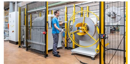
Eine Feinrichtmaschine entspannt das bis zu vier Millimeter starke und 300 mm breite Metallband ab Coil und ermöglicht die Fertigung von Bauteilen mit höchsten Ebenheitsanforderungen. (© Bildquelle: Nägeli Swiss AG)
