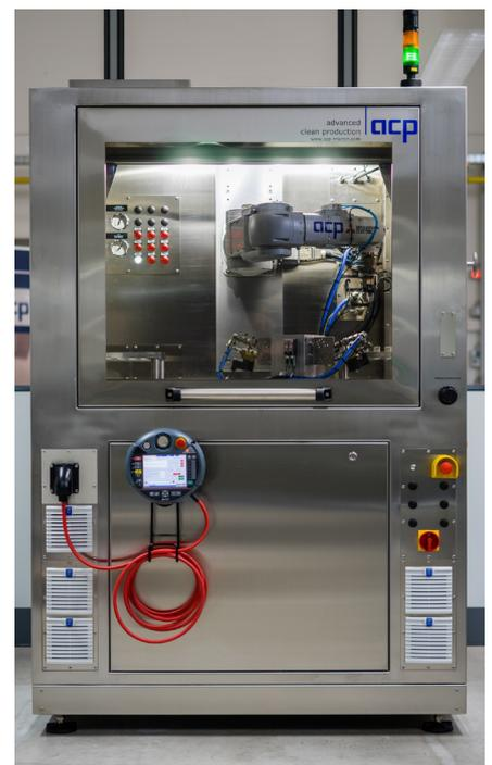
Bei dem für eine Anwendung in der Medizintechnik ausgelegte und in einen Reinraum integrierte quattroClean-System führt ein Roboter die Teile dem Strahlprozess zu. (Bildquelle: acp systems AG)
