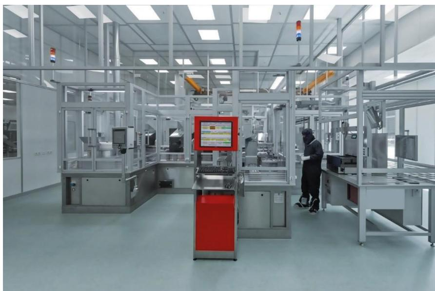
Produktion im Reinraum nach GMP Grade C der vorfüllbaren Kunststoffspritze mit Kanüle.
