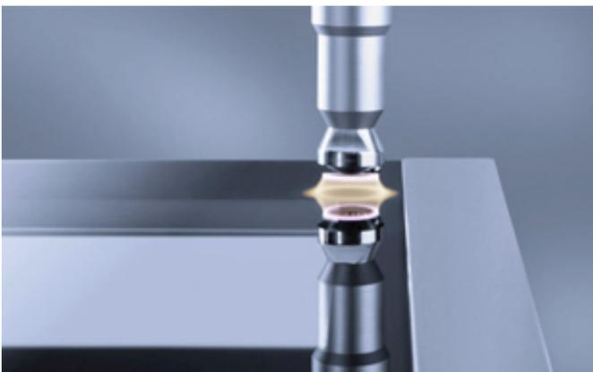
Die partielle Bauteilreinigung sichert durch lokal wirkende Reinigungstechnik die für nachfolgende Fügeprozesse wie Kleben, Schweißen oder Montage die erforderliche Sauberkeit am richtigen Ort. (Bildquelle: Plasmatreteat)
