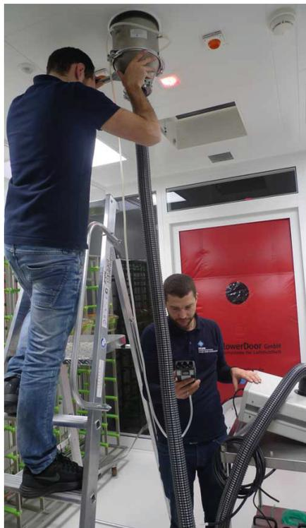
Abb. 1: Prüfung Leckluftvolumenstrom an Einzelkomponente
