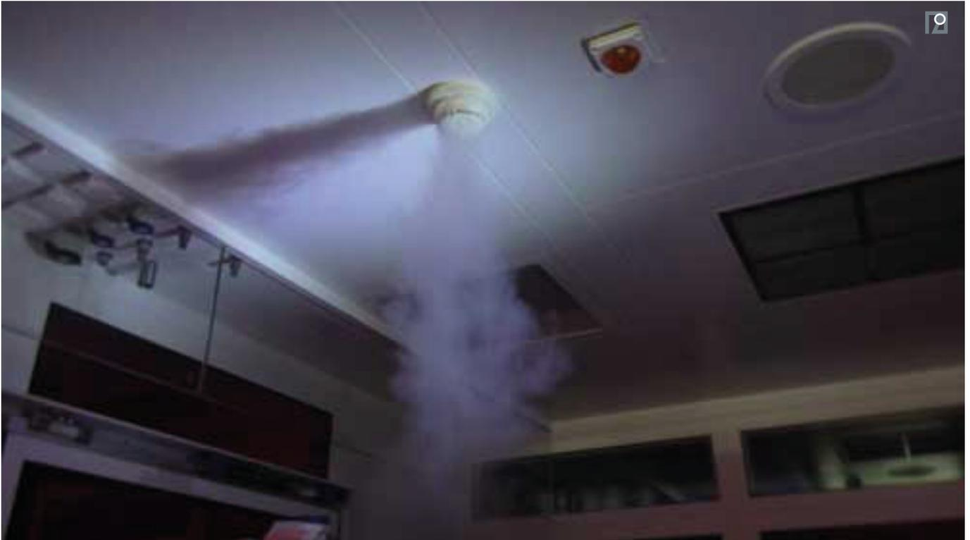
Abb. 2: Visualisierung des Leckluftvolumenstroms an einem Rauchmelder
