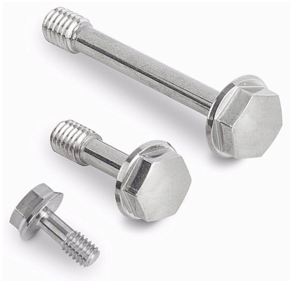
und Sicherungsscheibe der NovoNox KG verfügen über polierte Oberflächen und eine spezielle Formgebung. Auch ist der Schraubenkopf an der Stirnseite halbkugelig angelegt und der Kegelbund mit einer entsprechenden Formschräge ausgestattet. Mit einer Rauhtiefe von weniger als Ra 0,8 wurde auf störende Prägungen und Vertiefungen verzichtet. Schmutz und Reste von Reinigungslösungen haben so keine Chance, anzuhafeln.
