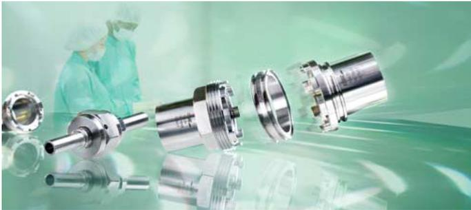
Die Verschraubung besteht im Aufbau aus drei Teilen: einem Gewindestutzen, einem Einlegeteil sowie einem metallischen speziellen Dichtring. Durch diesen metallischen Dichtring ist die Verbindung mit Heißdampf problemlos sterilisierbar und wesentlich beständiger gegen aggressive Medien als Weichdichtungen. Sie ist temperaturstabil von -273° C bis +400° C und unempfindlich gegenüber Umwelteinflüssen (z.B. auch gegenüber Salzwasser).
