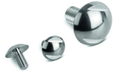
Die noch größere Kopfaufgabe, der gerundete Bund und ein Zentrierschaft für die USIT-Scheibe sorgen für ein Höchstmaß an Sicherheit. Ermöglicht wird damit auch ein paarweiser Einsatz an den Innen- und Außen-seiten mittels Kugelschraube Hygienic USIT® und der entsprechenden Gegenseite mit einem Innengewinde.
