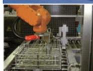
Sinnvoll in den innerbetrieblichen logistischen Ablauf eingebundene Reinigungsbehältnisse reduzieren unproduktive und kostspielige Umsetzvorgänge und sorgen dadurch für hohe Kosteneinsparungen. (Foto: Metallform)
