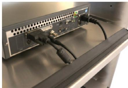
Integrierte Kabelkanäle und beidseitig großzügig ausgelegte Trägersysteme sorgen für ein optimiertes Kabelmanagement. (Bild: Kögel GmbH)
