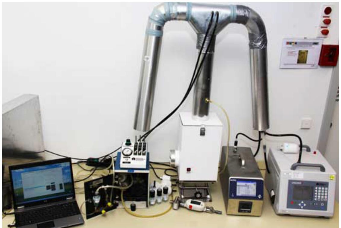
Bild 1: Kalibrierstand für Partikelzähler nach ISO 21501-4 (Foto: PMT Partikel-Messtechnik GmbH)
