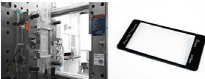
Auf der schließseitigen Werkzeugseite wird der Rahmen des 5" großen Displays mit der IMD-Einheit direkt beim Spritzgießen dekoriert
