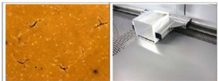
Abb. 7: links: Risse in einer Materialoberfläche unter 50-facher Vergrößerung. Rechts: Linearer Wischsimulator
