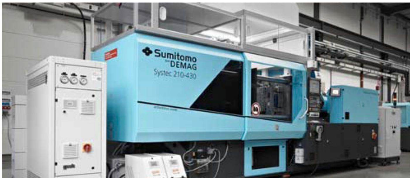
Kompakte Produktionszelle mit einer Systec 210, die IML- und IMD-Technik miteinander kombiniert. Hierauf entsteht effizient in einem Schuss ein multitouchfähiges Display.
