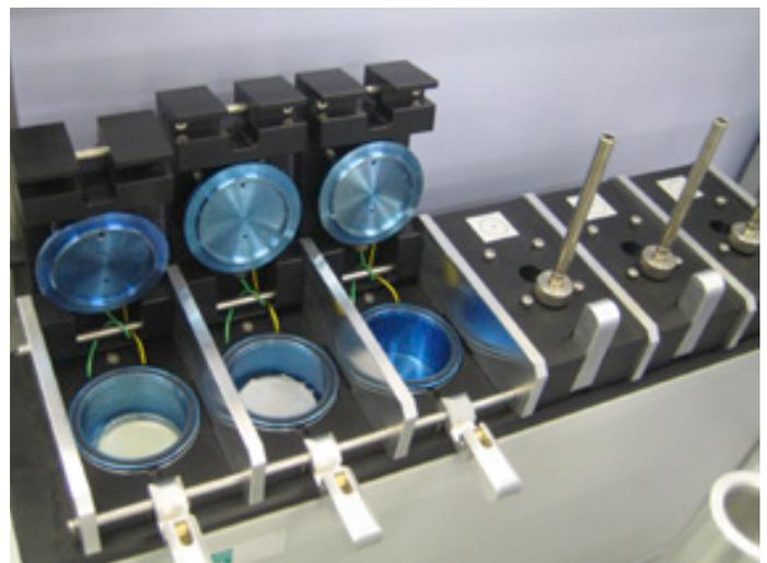
Abb. 2 : Mikro-Emissionskammer am Fraunhofer IPA zur Ermittlung von VOC-Emissionsklassen von Materialoberflächen
