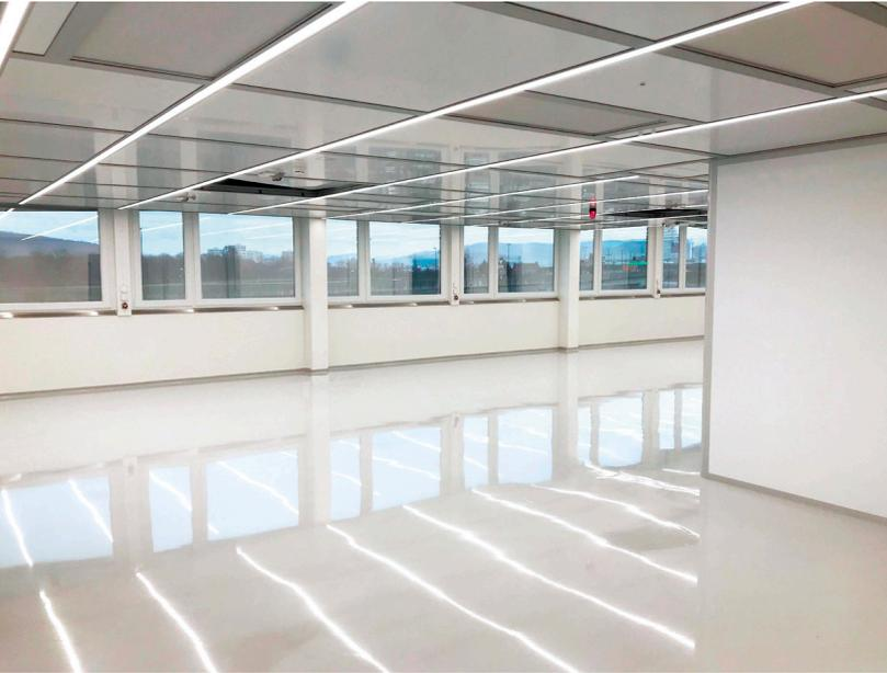
Der Reinraum kurz vor Fertigstellung. Die Fenster des Bestandsbaus wurden abgedichtet und in den Reinraum integriert, um Platz zu gewinnen.
