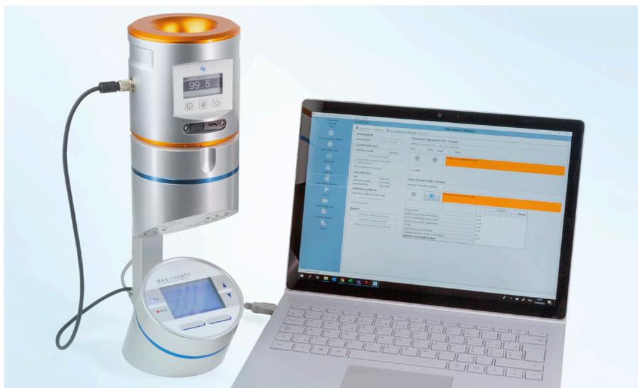
Die MBV AG als weltweiter Marktführer im mikrobiellen Monitoring von Luft bringt das digitale Anemometer MAS-100 Regulus® auf den Markt. Das MAS-100 Regulus ist das Nachfolge Kalibriergerät des DA-100 NT® und löst dieses als weltweiter Standard für die Kalibrierung und Justierung des Luftstroms von mikrobiellen Luftkeimsammlern MAS-100 ab.
