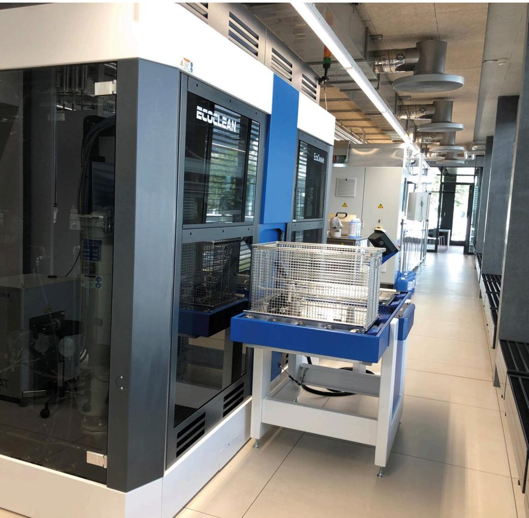
Das neue Testzentrum der Borer Chemie AG ist unter anderem mit einer EcoCwave und einer mehrstufigen Ultraschall-Feinstreinigungsanlage für die Durchführung von Reinigungsversuchen ausgestattet.
