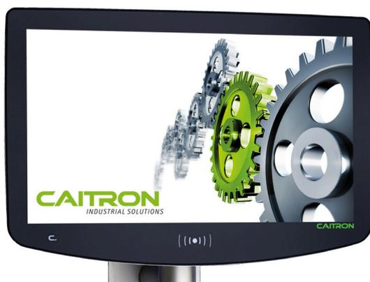
Gepriüfte Sicherheit für Reinraumumgebungen: Das Fraunhofer IPA hat die CAITRON Cleanroom HMI CR-Serie auf ihre Eignung in hygienischen Bereichen bis GMP-Klasse A/B gemäß EU GMP Annex 1 getestet und zertifiziert.
