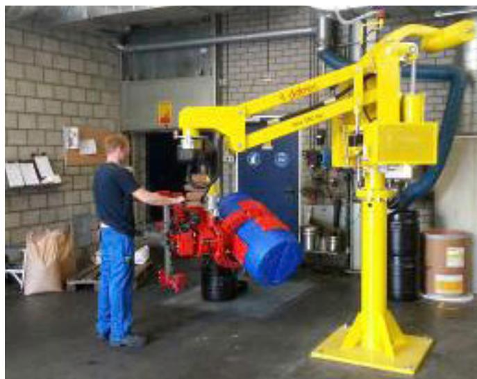
Mit der Anlage können alle Arten von Fässern sicher gehoben, gedreht und entleert werden. Der Antrieb ermöglicht ein präzises Ausgießen, der Handhabungs-Manipulator kompensiert den Gewichtsverlust und bleibt in der Z-Achse stehen, ohne zusätzliche Betätigung einer Steuerungseinheit. (Quelle: Dalmec GmbH)
