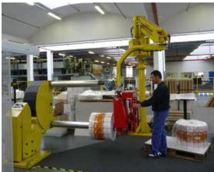
Die Manipulator kann stehend, am Boden verfahrbar, hängend oder deckenverfahrbar ausgeführt werden. (Quelle: Dalmec GmbH)
