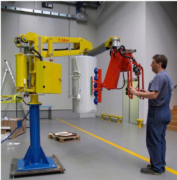
Je nach individueller Ausformung der Aufnahmevorrichtung können die verschiedensten Produkte präzise ausgerichtet werden. (Quelle: Dalmecc GmbH)
