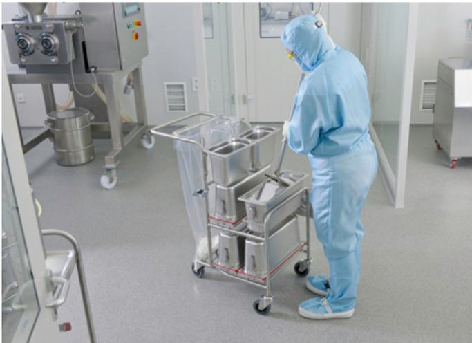
EasyMop GMP-Box: Das GMP-konforme und komplett auf Basis der Hygienic-Design-Empfehlungen entwickelte System ist speziell für Bereiche, in denen keine offenen Flüssigkeiten, eine möglichst geringe Partikelemission und eine hohe Validierbarkeit gefordert sind. Das System muss geschult werden, eine Fehlbedienung ist dann aber ausgeschlossen.
