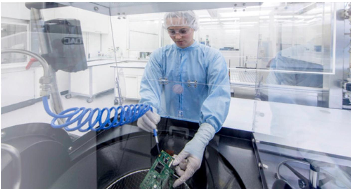
Extraktion der Partikel von einem Bauteil nach VDA Band 19.1. (Quelle: Fraunhofer IPA)
