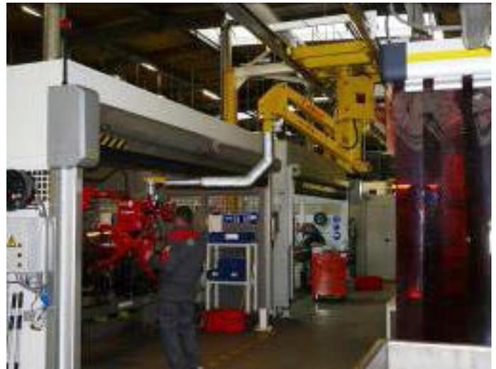
Die Manipulator kann stehend, am Boden verfahrbar, hängend oder deckenverfahrbar ausgeführt werden. (Quelle: Dalmecc GmbH)
