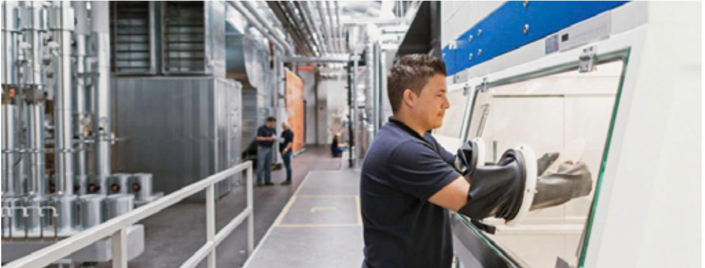
Reinraumtechnik: Über eine Materialschleuse wird das Kunststoffgranulat in einen Trocknungstrichter überführt
