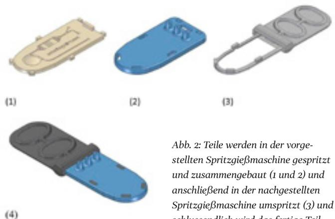
Abb. 2: Teile werden in der vorgestellten Spritzgießmaschine gespritzt und zusammengebaut (1 und 2) und anschließend in der nachgestellten Spritzgießmaschine umspritzt (3) und schlussendlich wird das fertige Teil entnommen und abgelegt (4).
