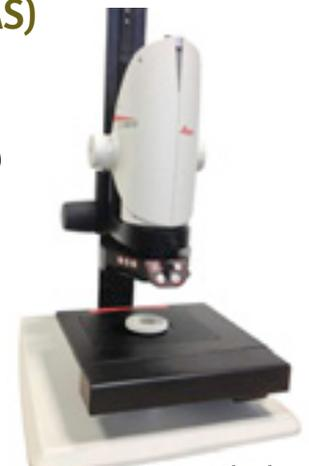
Das Mikroskopsystem Leica DMS300 Cleanliness Expert erlaubt Längen- und Breitenmessungen kleinster Partikel bis 20 Mikrometer sowie die Differenzierung zwischen reflektierenden und nicht-reflektierenden Partikeln.
