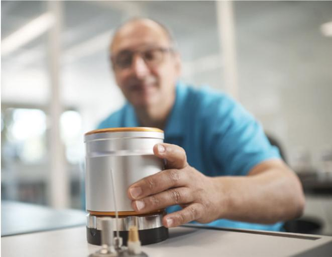
Ein DA-100 NT Digitalanemometer zur Kalibrierung des Luftflusses von MAS-100 Luftkeimsammlern wird im ISO 17025 akkreditierten Kalibrierlabor von MBV überprüft.
