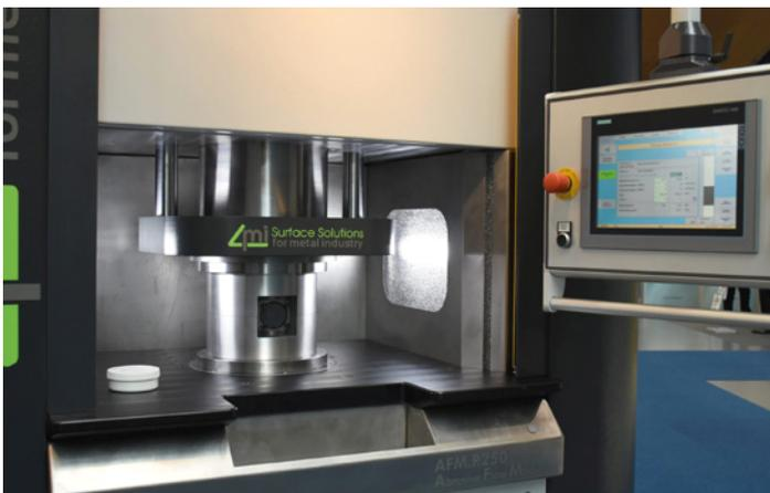
Das Abrasive Flow Machining (AFM), auch Druckfließläppen genannt, kommt sowohl bei konventionell als auch additiv hergestellten Bauteilen für das Entgraten und die Herstellung von Präzisionsoberflächen zum Einsatz. (Bildquelle: fairXperts)
