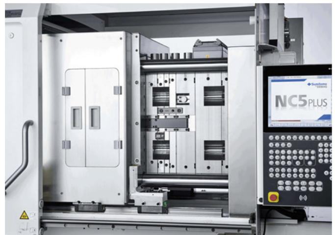
Die GMP-gerechte Ausführung des Werkzeugbereichs schützt vor Staubpartikeln und gewährleistet eine kontaminationsfreie Produktion.
