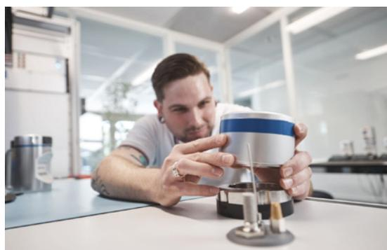
Ein DA-100 NT Digitalanemometer zur Kalibrierung des Luftflusses von MAS-100 Luftkeimsammlern wird im ISO 17025 akkreditierten Kalibrierlabor von MBV überprüft.
