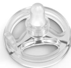
Auf einer ENGEL victory 860/160 produziert ENGEL während der Fakuma Entlüftungsventile für Getränkeflaschen. Die im Durchmesser ca. 50 mm großen Bauteile weisen eine geometrisch komplexe Struktur mit wechselnden Wanddicken auf. (Bild: ENGEL)
