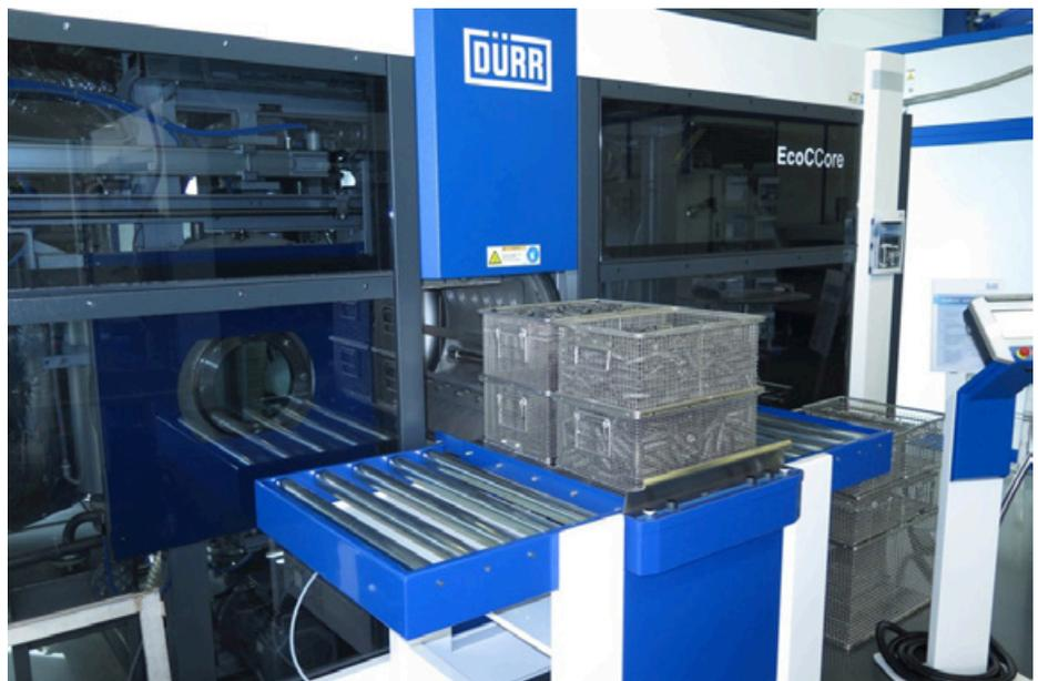
Durch schnelle Prozesse und das große Chargenmaß von 670 x 480 x 400 mm ermöglicht die Lösemittel-Reinigungsanlage EcoCCore reduzierte Stückkosten im Reinigungsprozess und vergleichsweise kurz Amortisationszeiten. (Bildquelle: TEMA Marketing)
