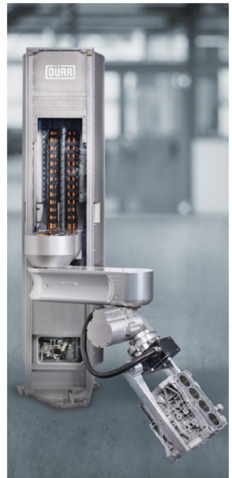
Als erster, speziell für den Einsatz in Roboterzellen entwickelter Manipulator überzeugt der Scara durch eine robuste Konstruktion mit Schutzklasse IP 69 und die anwenderfreundliche Programmierung und Bedienung über die CNC-Steuerung der Reinigungsanlage. (Bildquelle: TEMA Marketing)
