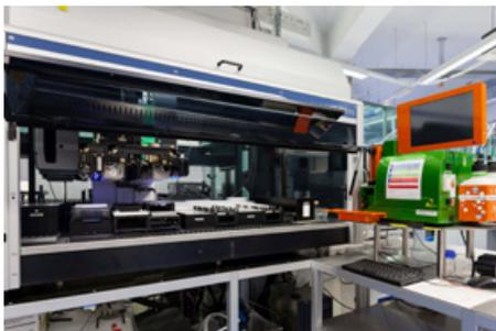
Robotergriffarm zur Bestückung und Lagerung verschiedener Probenhalterungen und Messeinrichtung zum vollautomatischen Auswerten der laufenden Experimente (rechts). (© TU Berlin/PR/Felix Noak)
