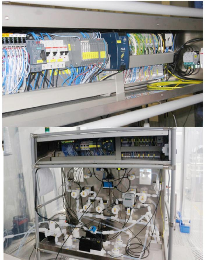
neben einem automatisierten Regenerationsprozess auch die Montage eines zweiten Filters erlaubt. Sobald der erste Filter den Regenerationsprozess erfolgreich durchlaufen hat, schaltet der Filterregenerationsstand automatisch den Regenerationsprozess für den zweiten Filter frei während der Prozess für den ersten Filter zeitgleich geschlossen wird.
