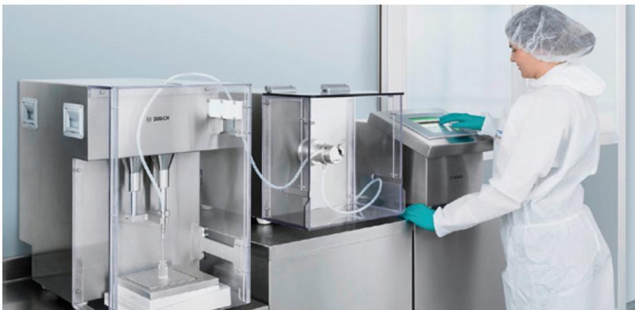
Laboranlage FHM 1000: Die halbautomatischen, modularen Laboranlagen der FHM 1000-Serie sind für die flexible Abfüllung flüssiger Pharmazeutika im Labor und in frühen Phasen klinischer Studien geeignet.
