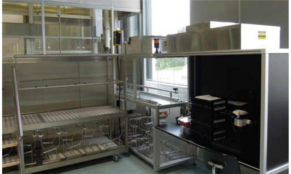
Nach der Reinigung transportiert das gekapselte und mit einer Flow-Box ausgestattete Entladeband die Optiken zu einer Kontrollstation, wo sie unter Reinraumbedingungen geprüft werden. (Bildquelle: UCM)
