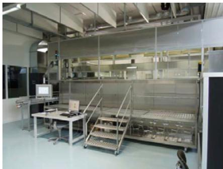
Die kompakte Anlage zur Feinstreinigung von optischen Linsen und Optiken ist komplett gekapselt und verfügt über acht Wannen. (Bildquelle: UCM)
