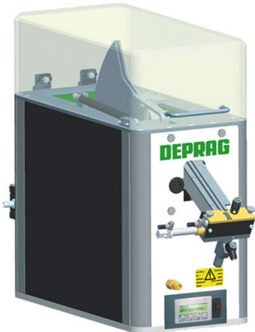
Fördergut im Vorratsbehälter wird durch eine Schwenkbewegung einer entsprechend angepassten segmentförmigen Hubschiene geschöpft. Auf dieser Schiene gleitet das Fördergut mittels Schwerkraft durch mechanische Schikanen hindurch und gelangt so sortiert in die Schraubenvereinzlung. Nicht lagerichtig geförderte Teile, gelangen durch mechanische Schikanen wieder in den Füllbehälter.
