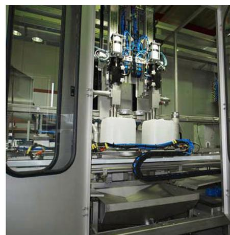
Die Kabine der SMB-Abfüllanlage ist komplett aus Edelstahl gefertigt. Bis zu 200 Kanister in der Stunde können darin befüllt werden. (Foto: SMB)
