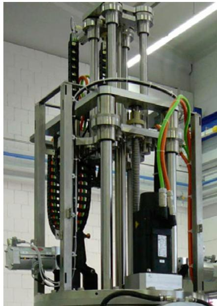
Das Transfersystem besteht aus vier Flansch-Kugelnbuchsen und vier Mittenflanschbuchsen. Der Antrieb für die Hubbewegung übernehmen zwei Kugelgewindespindeln. (Bild: Dr. Erich TRETTER GmbH + Co.)
