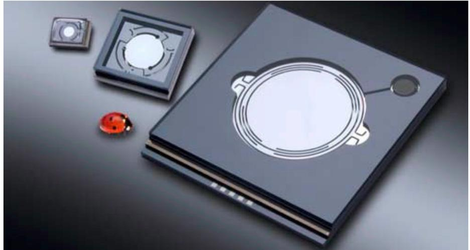
Verkippbare Silizium-Mikrospiegel für Anwendungen in der Bildprojektion, Abstandsmessung und Materialbearbeitung sind ein wichtiges Forschungsfeld der ISIT-Außenstelle an der Technischen Fakultät der CAU. (Foto/Copyright: Fraunhofer ISIT)
