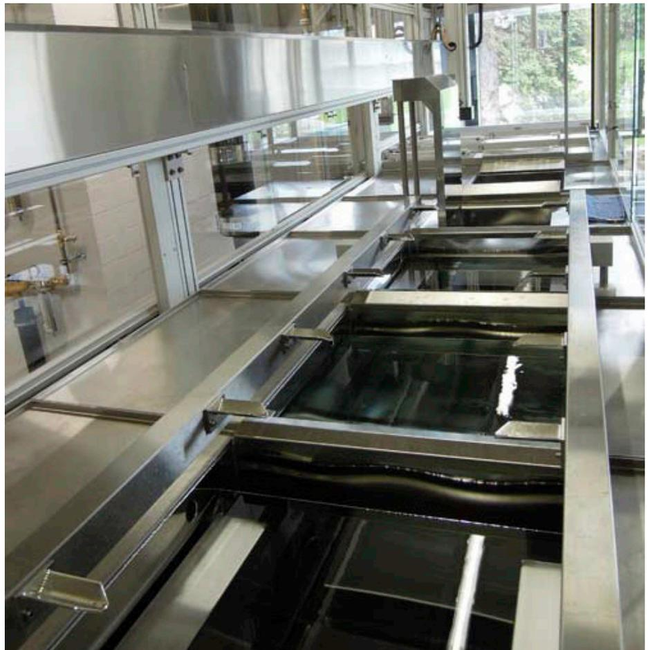
Die letzten beiden Wannen werden für die HFE-Trocknung genutzt und sind verdeckelt. Das Umsetzen der Teile erfolgt ohne Öffnen der Deckel. (Bildquelle: UCM)
