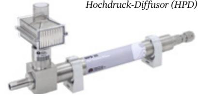
ler kann dessen Durchfluss-Kontrollsystem überfordern. Um dieses Problem zu lösen, wurden Hochdruck-Diffusoren (HPD) entwickelt. HPDs (Abbildung 2) reduzieren den Hochdruck auf den Normaldruck auf Meereshöhe. Sie wirken, in dem sie das überschüssige Gas in die Umgebung abgeben - oder diffundieren. So kann dann das Durchfluss-Kontrollsystem des Partikelzählers wie vorgesehen funktionieren.
