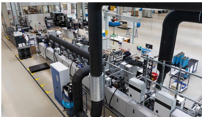
Die neue Fertigungslinie besteht aus einer Flexodruckmaschine, einer Vorkontrollmaschine, einem Bügelspender, einem Großrollen-Umwickler und zwei Endkontrollmaschinen.
