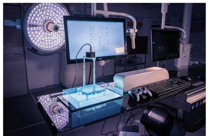
Aufbau zum Training und zur Validierung einer KI für die autonome Navigation eines Führungsdrahts. (Quelle: Fraunhofer IPA; Foto: Vanessa Stachel)
