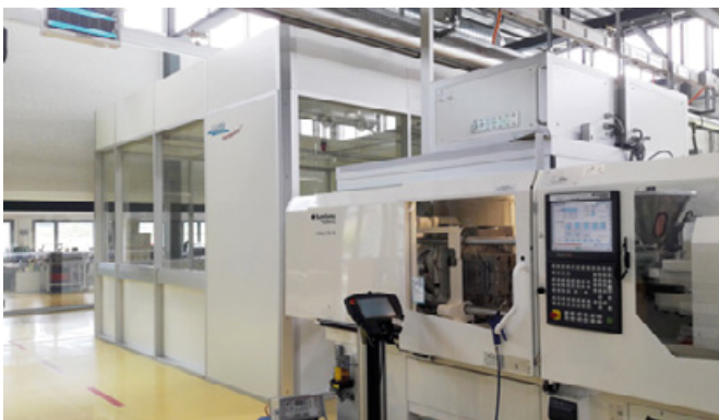
Reinraumlösung mit angedockter Spritzgießmaschine
