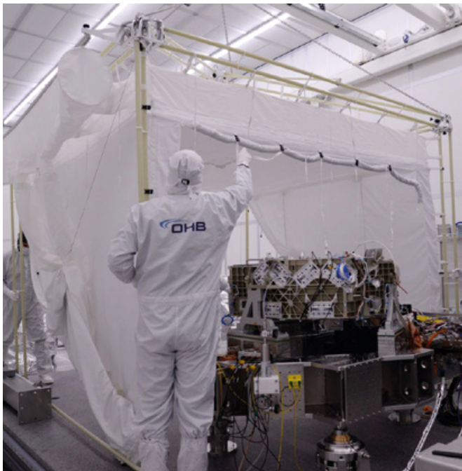
Aufbau des mobilen und autarken Reinraums CAPE® im OHB-Raumfahrtzentrum „Optik & Wissenschaft“ zum temporären Schutz empfindlicher optischer Systeme in einer Reinraumhalle der ISO-Klasse 5. (© OHB System AG)
