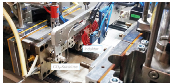
Werkzeugraum mit eingefahrenem Handling zur dynamischen Temperierung.
