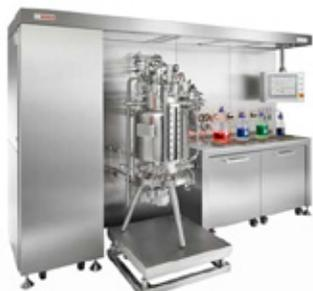
Pilotfermenter zur Herstellung biopharmazeutischer Wirkstoffe: Der modular aufgebaute, vollautomatische Pilotfermenter von Bosch eignet sich sowohl für Forschungs- und Entwicklungszwecke und klinische Studien im Labor als auch für die industrielle Produktion kleiner Chargen. (Foto: Bosch)
