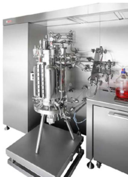
Batchverfahren und kontinuierliche Produktion: Die Ausstattung des Pilotfermenters ermöglicht neben Batch- und Fed-Batch-Prozessen auch Perfusion und kontinuierliche Verfahren. (Foto: Bosch)
