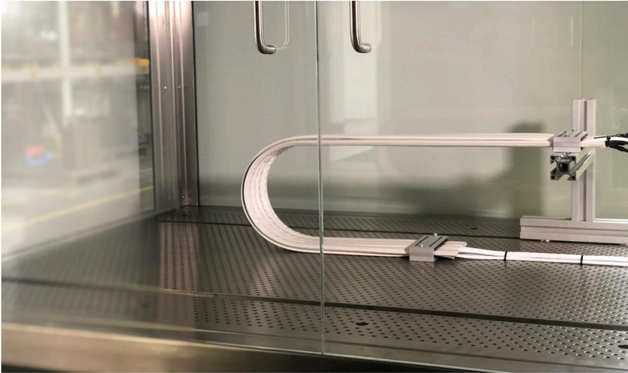
Die Tests zum Beispiel der e-skin Energieführungen finden gemäß der ISO 14644-14 Bedingungen in modularen Laminar Flow Boxen statt. (Quelle: igus GmbH)
