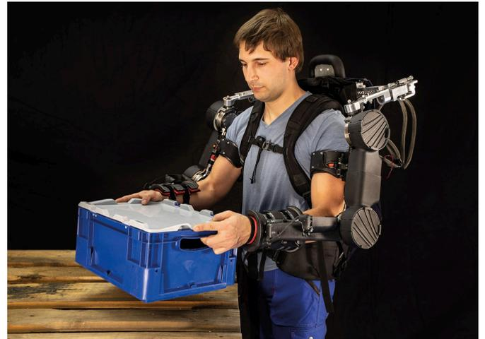
Das Stuttgart Exo-Jacket unterstützt den Oberkörper aktiv bei der manuellen Handhabung und insbesondere bei Hebe- und Überkopffähigkeiten. (© Fraunhofer IPA/Foto: Rainer Bez)
