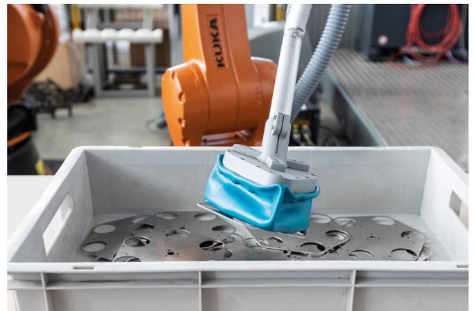
Im Rahmen der Initiative »Kognitive Robotik« werden beispielsweise Technologien zum maschinellen Lernen für den Griff-in-die-Kiste weiterentwickelt. (© Fraunhofer IPA/Foto: Rainer Bez)
