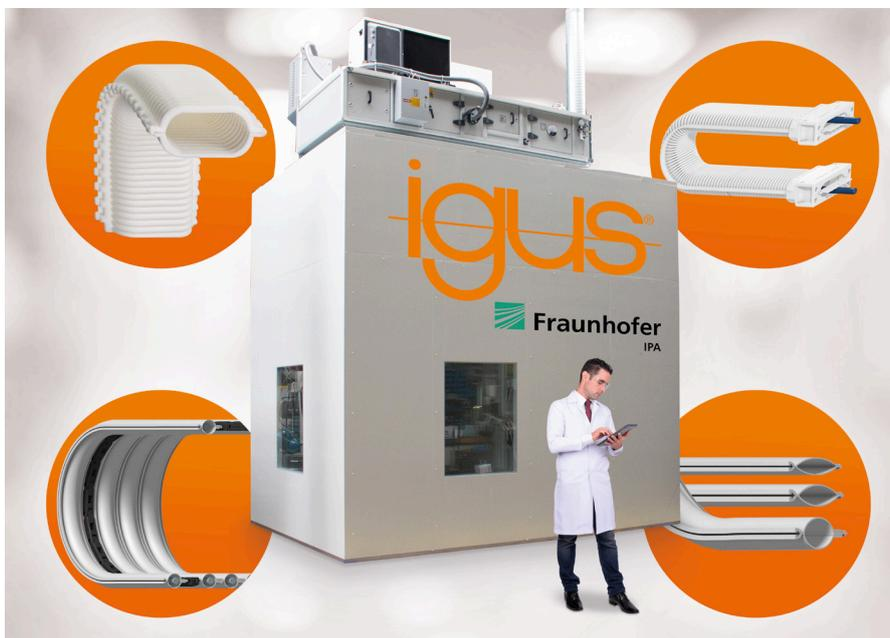
Das neue igus Reinraumlabor wurde vom Fraunhofer IPA für die schnelle Entwicklung partikelfreier motion plastics gebaut, die geeignet sind für Reinräume bis zur Luftreinheitsklasse 1 gemäß ISO 14644-1. (Quelle: igus GmbH)
