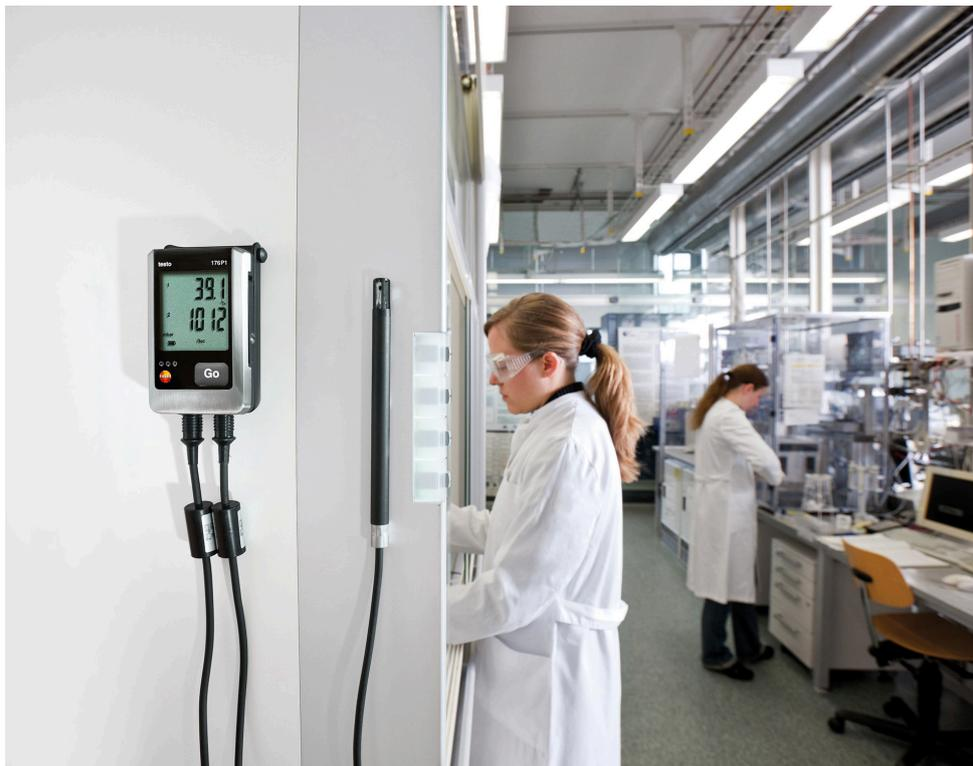
Überwachung des Absolutdrucks und der Luftfeuchte im Labor mit dem autarken Datenlogger Testo 176 P1.
