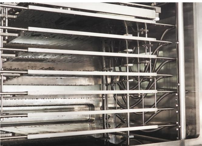
Bosch Gefriertrockner mit kippbaren Stellflächen: Schnelle Reinigung: Dank der leichten Neigung fließen letzte Wassertropfen zügig von der Oberfläche ab, wodurch sich die Wasch- und Trocknungszeit verkürzt. (Foto: Bosch)
