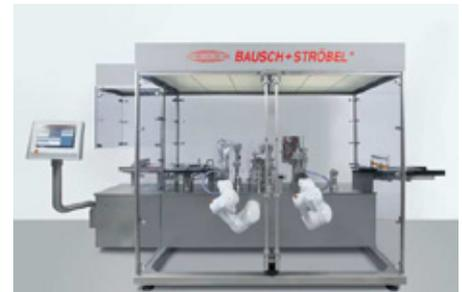
KCP: Durch den Einsatz von Reinraumrobotern bietet diese Füll- und Verschleißmaschine für die Kleinchargenproduktion ein sehr breites Spektrum an Einsatzmöglichkeiten. Die Besonderheit des B+S-Maschinendesigns: Die Roboterarme befinden sich niemals über, sondern immer unterhalb des Objekts, dadurch wird ein optimaler LF-Luftstrom gewährleistet.
