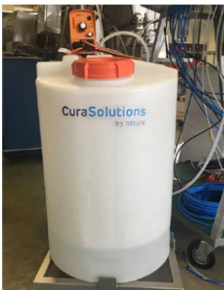
Die Zugabe der Hydro-L.O.G.s erfolgt über eine Dosieranlage, die den Wirkstoff automatisch an das Wasser abgibt. (Quelle: CuraSolutions GmbH)
