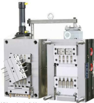
Abbildung des Spritzblaswerkzeuges
