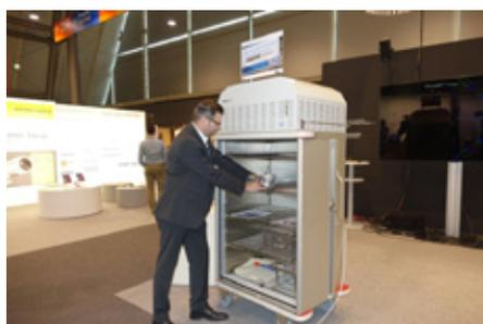
Der Schleusen-Transportwagen PUROS Science der Firma Kögel transportiert die zu prüfenden Teile sicher in das Sauberkeitslabor. (Quelle: Nerling Systemräume GmbH)
