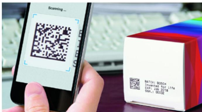
Zum Schutz der Patienten: Die Track & Trace-Lösung von Bosch für die pharmazeutische Industrie sorgt für die eindeutige Serialisierung von Sekundärverpackungen und gewährleistet die Rückverfolgbarkeit entlang der Fertigungskette. (Foto: Bosch)
