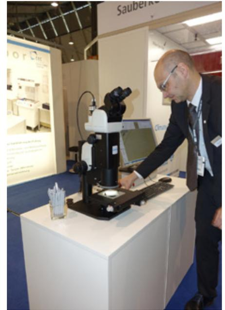
Mittels Mikroskop der Firma Jomesa werden Partikelart, -größe sowie -menge detektiert und automatisch analysiert mit anschließender Dokumentation durch Firma CleanControlling. (Quelle: Nerling Systemräume GmbH)
