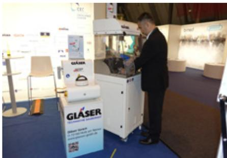
Im Spülkabinett der Gläser GmbH werden die Partikel von den Bauteilen extrahiert und dann die Filtermembran in nur 7 Minuten im Gläser EasyDry getrocknet. (Quelle: Nerling Systemräume GmbH)
