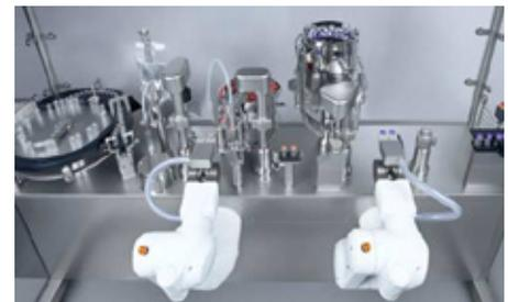
Ein möglicher Anwendungsfall: Hier sind eine Füll-, eine Stopfensetz- und eine Verschleißstation für Bördelkappen aufgebaut. Darüber hinaus ist eine IPC-Waage integriert.
