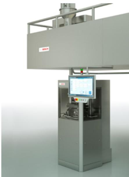
Effiziente Tablettierung auf der Xelum Plattform: Die integrierte Xelum Tablettenpresse mit Anbindung an das Human Machine Interface (HMI) der Xelum Plattform sorgt für eine effiziente Tablettierung. (Foto: Bosch)
