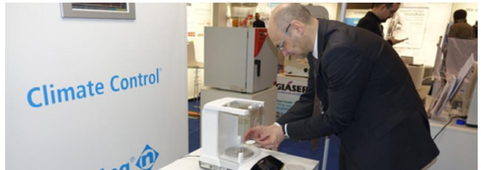
Zur Bewertung der Partikelmenge wird der Filter schließlich auf einer Präzisionswaage der Firma Sartorius gewogen. (Quelle: Nerling Systemräume GmbH)
