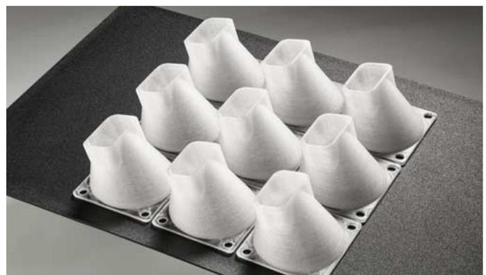
Für den Anwendungsbereich Raum- und Luftfahrt fertigt ein Freeformer auf den Rapid.Tech 2017 exemplarisch Luftkanäle aus einem speziell zugelassenen PC.
