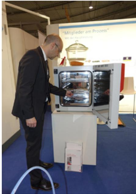
Für Partikelgrößen ab 25 µm wird der zuvor verwendete Filter im Trockenofen der Firma Binder getrocknet und im so genannten Exsikkator auf die vorgeschriebene Feuchte gebracht. (Quelle: Nerling Systemräume GmbH)
