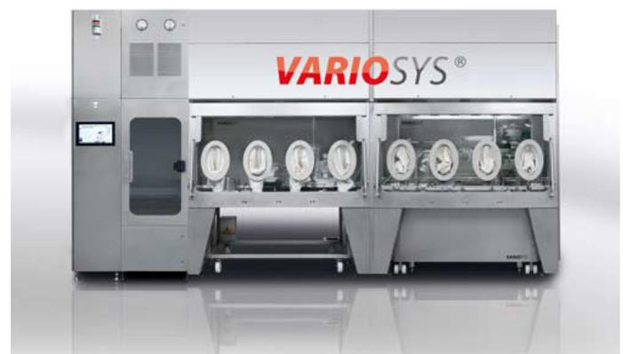
VarioSys: Ein sehr flexibles und zudem platz- und zeitsparendes System für die Kleinchargenproduktion. Mehrere Komponenten können, je nach Anforderung, als Produktionslinie aneinander gereiht werden.
