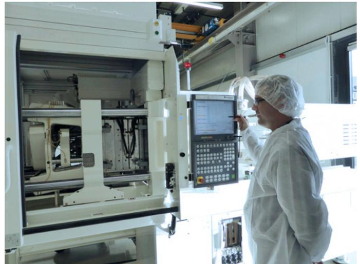
Tobias Lacroix, Leiter der Mikro-Spritzgießabteilung ist mit der neuen vollelektrischen Spritzgießmaschine IntElect von Sumitomo (SHI) Demag vollständig zufrieden: „Es kommt auf höchste Präzision des Bauteils an, um das fluidische Funktionsdesign des Schnelltests und damit ein hundertprozentig sicheres Ergebnis zu garantieren – und das ist uns mit der Maschine gelungen.“ (Foto: Sumitomo (SHI) Demag)
