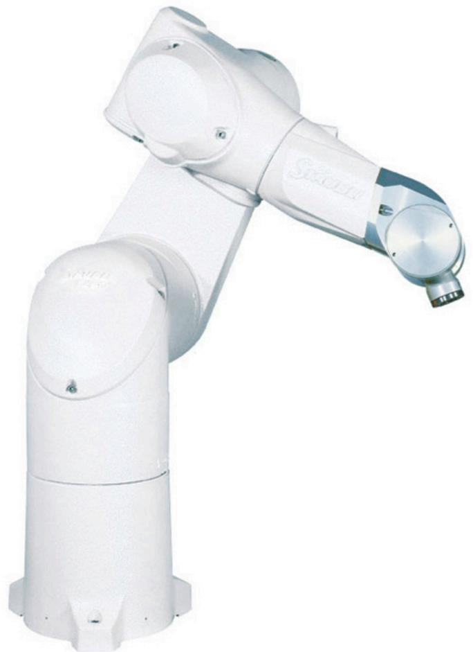
Reinraumroboter von Stäubli erfüllen ISO-Klasse 4 in cr-Ausführung und ISO-Klasse 2-3 in scr-Ausführung.
