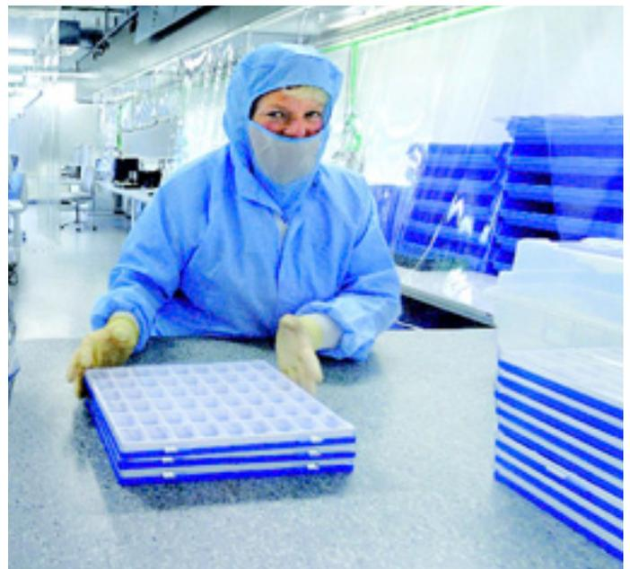
Hier herrscht das „Vermummungsgebot“: Die Mitarbeiter montieren und verpacken unter Reinraumbedingungen der Klasse 7 – da darf kein Haar oder Stäubchen in die Endprodukte gelangen. (Foto: thinXXS)
