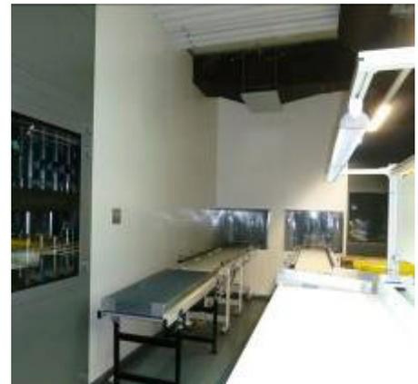
Vor dem letzten Verarbeitungsschritt – der Sterilisation – erfolgt noch die Umverpackung, bei der eine Bedienungsanleitung dazugelegt, das Ganze verschlossen und noch einmal etikettiert wird. (Quelle: Nerling Systemräume GmbH)
