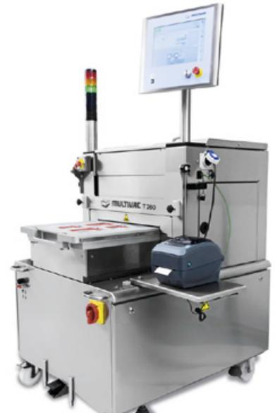
260 für das effiziente Verpacken von unterschiedlichen Produkten in kleinen und mittleren Losgrößen einsetzbar ist. Zur Erleichterung eines schnellen und ergonomischen Werkzeugwechsels bietet MULTIVAC einen entsprechenden Werkzeugwechselwagen, der optional mit einer Service-Einheit ausgestattet werden kann.
