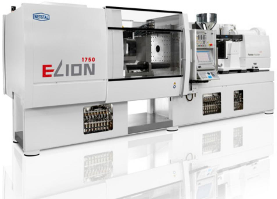
Die vollelektrische ELION eignet sich hervorragend für den Einsatz im Reinraum.
