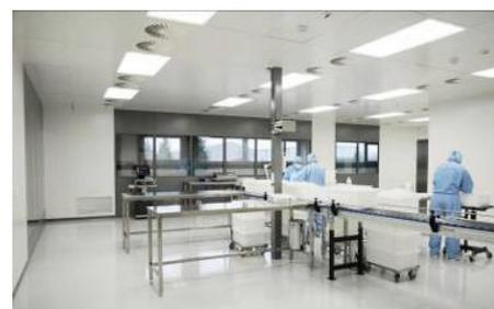
Die Instrumente müssen unter Reinraum-Bedingungen gemäß Klasse GMP C verpackt und versiegelt werden. (Quelle: Nerling Systemräume GmbH)
