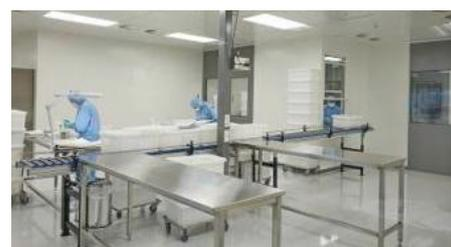
Die bei Nerling in Auftrag gegebene 16,90 x 16,88 m große Anlage befindet sich in einer neu gebauten Halle und umfasst neben dem eigentlichen Reinraum auch insgesamt sechs Schleusen. (Quelle: Nerling Systemräume GmbH)
