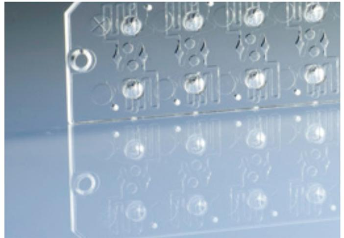
Mikrostrukturen, die mit dem bloßen Auge nicht mehr auflösen sind, fallen mit jedem Schuss aus der Spritzgießmaschine heraus. Jedes Teil nahezu ein Klon seines Vorgängers. (Foto: thinXXS)
