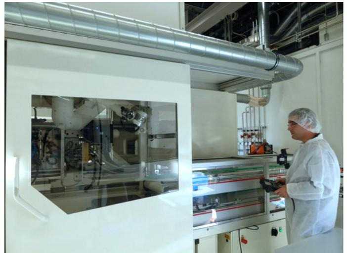
Während der Produktion ist der Blick nur durch die Glasscheibe gestattet. Reinraumbedingungen der Klasse 7 – von der Spritzgießmaschine über die Automatisierung bis zur Montage – verbieten eine nähere Berührung. (Foto: Sumitomo (SHI) Demag)
