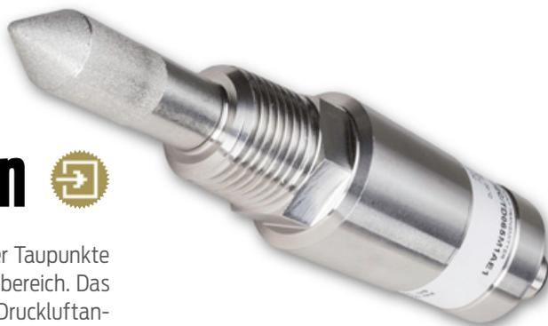
Der kompakte Taupunktmessumformer EE355 ermöglicht die Messung niedriger Taupunkte bis -60°C Td mit einer hohen Messgenauigkeit von  $\pm 1,2^\circ\text{C Td}$  im gesamten Messbereich. Das Gerät bietet ein optimales Preis-/ Leistungsverhältnis für OEM Anwendungen in Druckluftanlagen, Kunststofftrocknern und industriellen Trocknungsprozessen.
