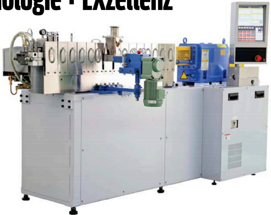
TEX 25 Alpha III, gleichlaufender Doppelschneckenextruder
