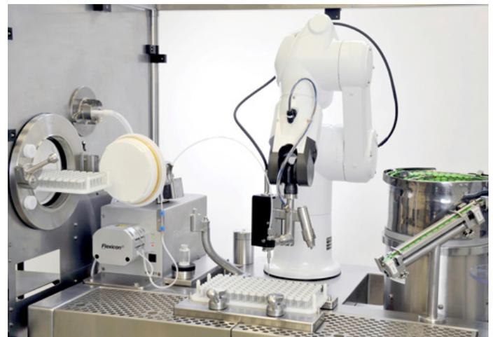
Der TX60 Stericlean ist zuständig für das aseptische Befüllen pharmazeutischer Produkte. Die Anlage schafft bis zu 600 Vials pro Stunde.
