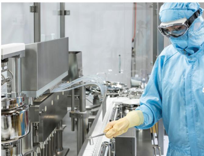
Bosch ALF 5000 für maximale Flexibilität: Die ALF 5000 Füll- und Verschließanlage verarbeitet in der Kombi-Ausführung zusätzlich zu Ampullen auch Injektionsflaschen. (Foto: Bosch)
