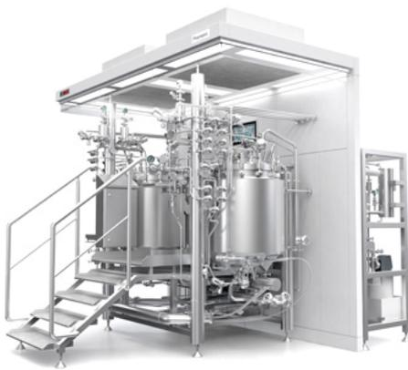
Prozessanlage SVP250 zur Herstellung von Injektionslösungen: Die neue Bosch Prozessanlage vom Typ SVP250 LF ist für die Produktion kleiner Chargen von 15 bis 250 Liter ausgelegt. Sie besteht aus je einem Ansatz- und Lagerbehälter. (Foto: Bosch)
