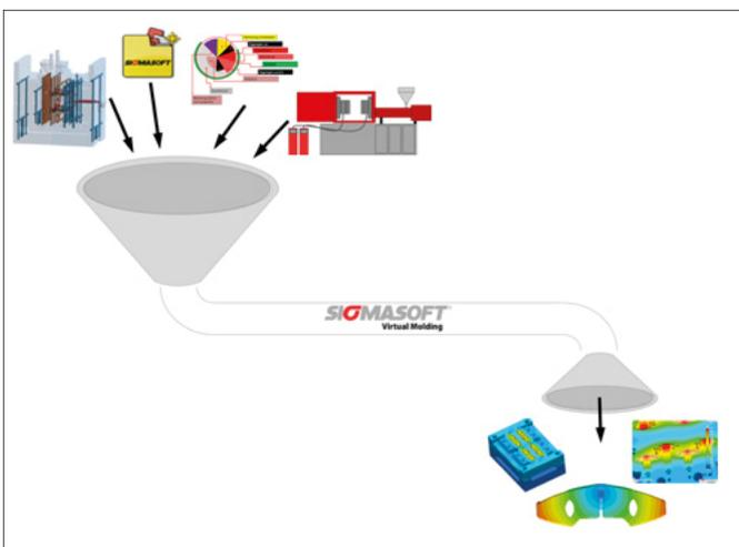
Abbildung 1 – Bei konventionellen Ansätzen für Spritzgussimulationen stellt der Benutzer eine Kombination aus Geometrien, Materialien und Prozesseinstellungen bereit und erhält ein Ergebnis für diesen spezifischen Punkt im Prozessfenster.
