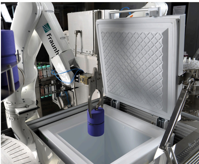
Automatisiert gesteuerte 6-Achs-Roboter transportieren Zellen und Materialien innerhalb der Anlagen. Mit den speziell geformten Greifern können Objekte verschiedener Formen und Größen bewegt werden. (© Fraunhofer IPT)
