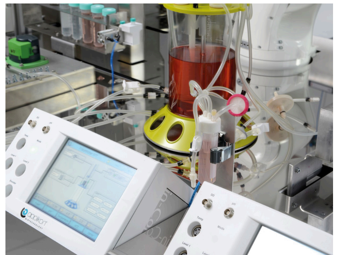
In den Bioreaktoren werden die Zellen um ein Vielfaches vermehrt. Sie werden entnommen, sobald die gewünschte Zellzahl erreicht ist. Die Kontrolle von Temperatur und Gaszusammensetzung, die Zählung der Zellen als auch die Entnahme laufen vollständig automatisiert ab. (© Fraunhofer IPT)
