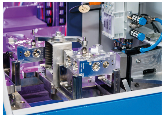
Der Entgratprozess kann mit der serienmäßigen Einzelspindel oder einem optionalen, mit bis zu fünf Entgratwerkzeugen ausstattbaren Revolver stattfinden. Es lassen sich dabei Zykluszeiten von 15 Sekunden pro Palette realisieren.
