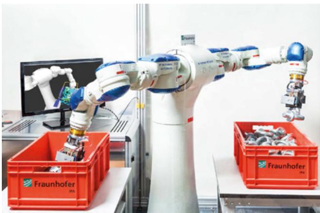
Mithilfe des Maschinellen Lernens wird der Griff-in-die-Kiste immer weiter verfeinert. Im Forschungsprojekt »DeepGrasping« entsteht aktuell eine virtuelle Lernumgebung für Roboter. (Quelle: Fraunhofer IPA, Foto: Rainer Bez)
