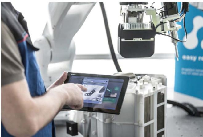
Die Software drag&bot liefert fertige Programmbausteine, die sich über eine grafische Bedienoberfläche schnell und intuitiv zu komplexen Roboterapplikationen zusammenfügen lassen. (Quelle: Fraunhofer IPA, Foto: Rainer Bez)
