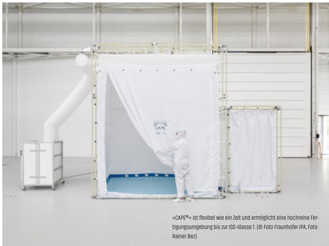
»CAPE®« ist flexibel wie ein Zelt und ermöglicht eine hochreine Fertigungsumgebung bis zur ISO-Klasse 1. (© Foto Fraunhofer IPA, Foto: Rainer Bez)
