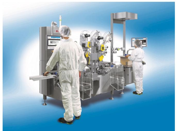
CPS 1900 WTE und CPA410: Das Carton Printing System 1900 WTE von Bosch verfügt über eine integrierte Kontrollwaage und serialisiert die kleinste verschließbare Einheit (zum Beispiel Faltschachteln). Darüber hinaus bietet Bosch das CPA für die Aggregation von Bündeln, Kisten oder Paletten an. (Foto: Bosch)
