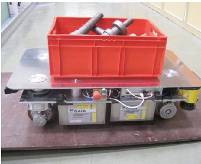
Fahrerlose Transportsysteme müssen Lasten unterfahren, um sie aufnehmen zu können. Sie sollten also möglichst flach sein. Das neu konstruierte omnidirektionale Antriebsmodul kommt deshalb mit einem sehr geringen Bauraum oberhalb des Rades aus. (Quelle: Fraunhofer IPA)
