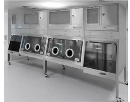
Sind Hersteller bei der Produktion von Arzneimitteln und Implantaten auf Zulieferer oder externe Materialien angewiesen, ist die Anwendung eines sogenannten Restricted Access Barrier Systems (RABS) möglich. Diese sorgen für ein hochreines Arbeitsumfeld, in dem Eingriffe nur durch fest installierte Handschuhe möglich sind. Alle Materialien werden durch ein Schleusensystem in den Arbeitsbereich eingebracht, was einen ungestörten Herstellungsprozess garantiert. (Quelle: bc-technology GmbH)
