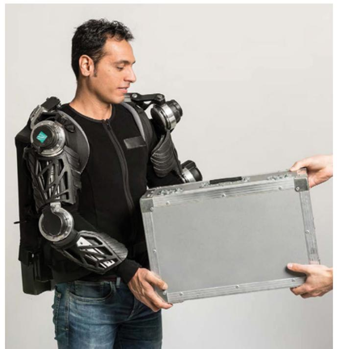
An Ellenbogen und Schultern haben die Experten Antriebsmodule integriert, die Bewegungen mit hohem Drehmoment unterstützen. (Quelle: Fraunhofer IPA, Foto: Rainer Bez)
