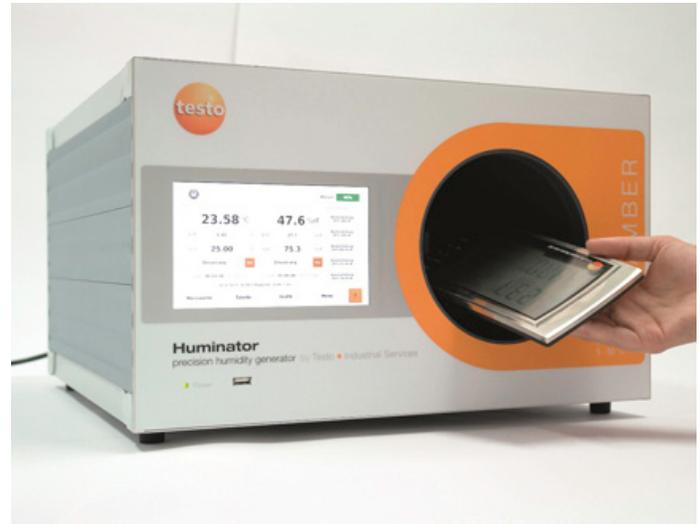
Dank der geräumigen Messkammer lassen sich auch größere Geräte kalibrieren. (Bild: Testo I. S. GmbH)
