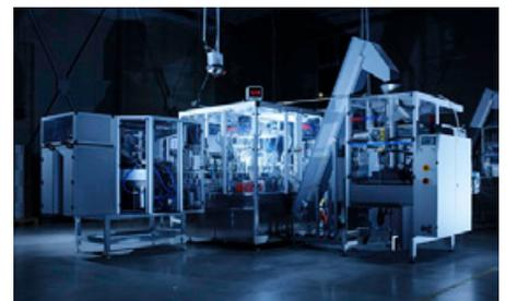
Die Rundtaktanlage für die Montage von Kunststoff-Clips ist für eine Ausbringung von 240 Teilen in der Minute konzipiert. Sie ist mit einer Verpackungseinheit verkettet. (Foto: Contexo GmbH)
