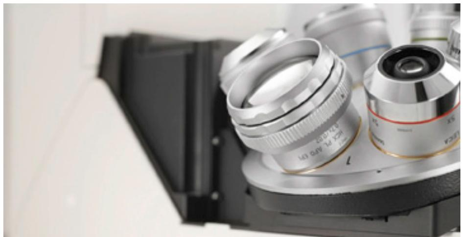
Das Leica DMi8 kann mit einem exklusiv von Leica Microsystems angebotenen Makroobjektiv ausgerüstet werden. Verglichen mit herkömmlichen Objektiven wird hiermit das Sichtfeld bis zum Vierfachen vergrößert.
