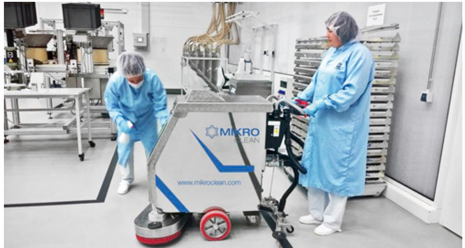
Durch ihre besondere Ableitfähigkeit ist die Maschine auch ideal in ESD-Schutz-zonen (Electro Static Discharge) einsetzbar. Die verwendeten Materialien sind elektrisch leitfähig, alle beweglichen Teile sind mit dem Chassis verbunden, dieses wird durch ein antistatisches Ableitband über den Fußboden geerdet.
