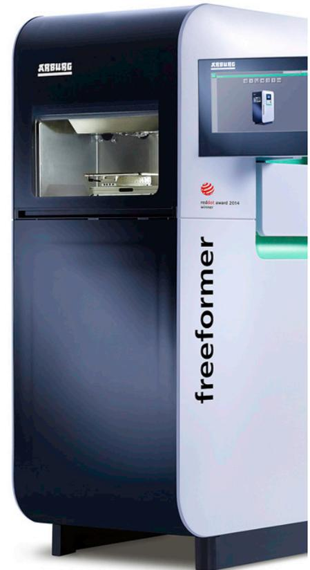
Industrielle additive Fertigung: Mit dem Freeformer und dem Arburg Kunststoff-Freiformen (AKF) lassen sich Funktionsbauteile werkzeuglos aus Standardgranulat produzieren. (Foto: ARBURG)
