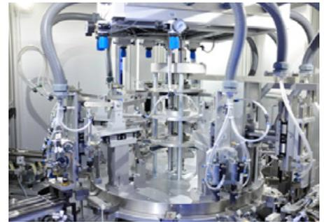
Hochleistungs-Rundtaktanlage: Die Basis bildet ein mechanischer Rundtisch mit Pick-&-Place-Einheiten, die über zentrale Kurvenscheiben angetrieben werden. (Foto: Contexo GmbH)
