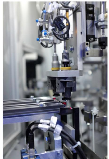
Die Komponenten werden auf den getakteten Anlagen zugeführt und vereinzelt. (Foto: Contexo GmbH)
