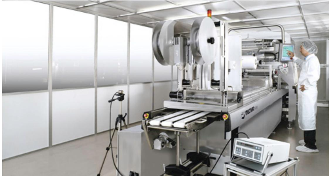
An die Reinheit von medizinischen Sterilgütern – beispielsweise Implantaten oder OP-Bestecken – werden höchste Ansprüche gestellt. Deshalb müssen diese auch unter Reinraumbedingungen verpackt werden, um die Reinheit der Produkte entlang der gesamten Lieferkette zu garantieren. MULTIVAC bietet seit vielen Jahren Verpackungsmaschinen an, die eine sichere Verpackung von Steril- und Medizingütern im Reinraum ermöglichen.
