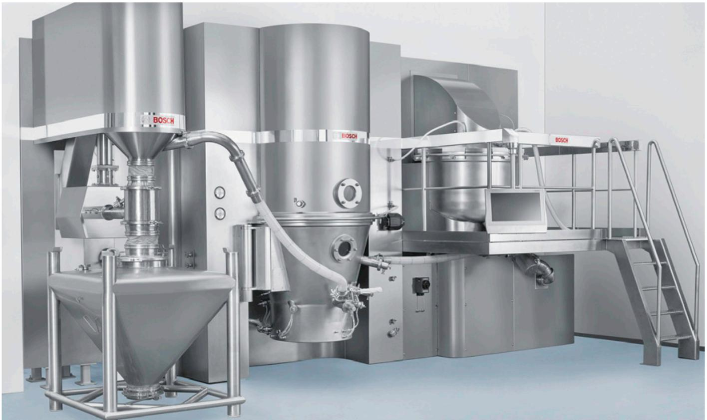
Neue Granulierlinie Hüttlin Granulean: Die in drei standardisierten Größen verfügbare neue Granulierlinie Hüttlin Granulean umfasst alle Prozessschritte vom Mischen und Trocknen bis hin zum Granulieren. (Foto: Bosch)
