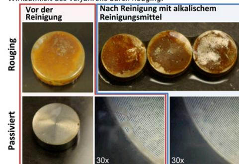
ASTM E 2871-13 (Einzelrohrmethode): Quantifiziert die erhöhte Desinfektionsresistenz des rougingbehafteten Biofilmblechs.
