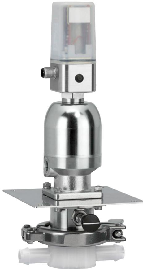
für die Mehrfachnutzung in der Anlage. Der aus Polypropylen im Reinraum hergestellte Ventilkörper ist bis 50 kGy gamma-sterilisierbar und trennt durch eine ultraschallverschweißte TPE-Membrane das Betriebsmedium hermetisch von der Umgebung und vom
