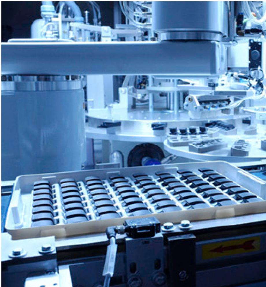
Contexo entwickelt ganz unterschiedliche Anlagen – zum Beispiel Automaten, die lackierte Kunststoff-Bedienelemente entstückeln und prüfen. Anschließend werden die Bauteile in Verpackungsblistern abgesetzt. (Foto: Contexo GmbH)
