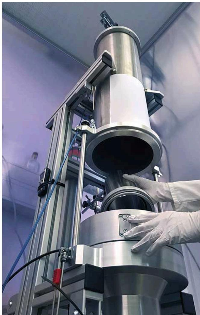
Filterprüfstand zur Messung des Partikelrückhaltevermögens. (© Fraunhofer IPA/Foto: Tanja Eisermann)
