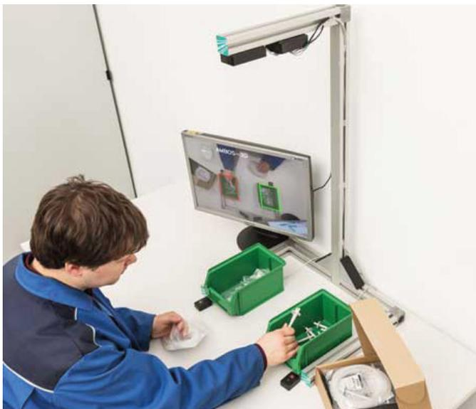
Das teilautomatisierte Montageassistenzsystem MonSiKo erkennt dank intelligenter Algorithmen und leistungsstarker 3D-Sensoren, welcher Arbeitsschritt gerade vollzogen wird und schreitet bei Fehlern ein. (© Fraunhofer IPA/Foto: Rainer Bez)
