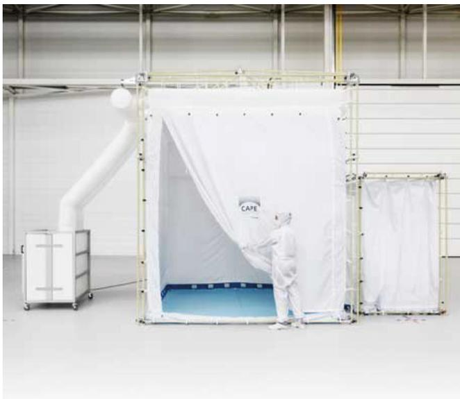
Mit CAPE® haben Wissenschaftler vom Fraunhofer IPA ein mobiles, zeltähnliches Reinraumsystem entwickelt, das sich in weniger als einer Stunde aufbauen lässt. (© Fraunhofer IPA/Foto: Rainer Bez)
