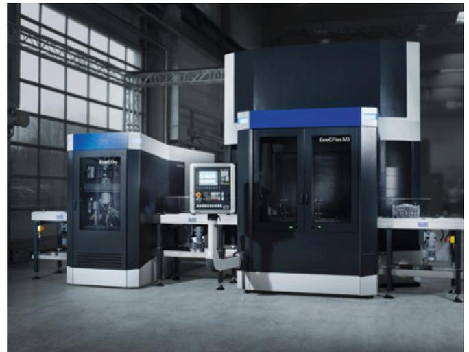
Die Roboterzelle EcoCflex 3 setzt bei der Reinigung von Motoren- und Getriebeteilen in der Automobilindustrie unter anderem durch den speziell entwickelten Scara-Manipulator Standards. Foto: UCM\_Feinstreinigung
