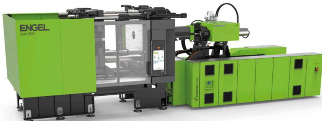
Für die Herstellung dickwandiger LED-Linsen verkettet ENGEL auf der Chinaplas zwei Spritzgießmaschinen vom Typ duo. (Bild: ENGEL)
