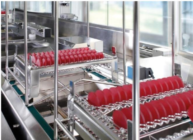
Für höchsten Sauberkeitsanforderungen werden Reinigungsprozesse und Ultraschall-Feinstreinigungsanlagen ausgehend von Teilegeometrie, Material, Verschmutzung und Sauberkeitsanforderung der Teile maßgeschneidert entwickelt. Bildquelle: Ecoclean GmbH
