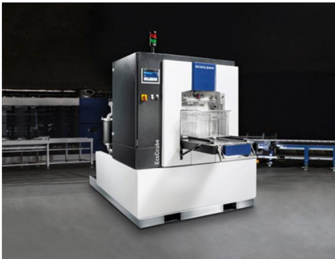
Durch ihr Aufstellmaß und ihr geringes Gewicht sowie die optimal abgestimmte Größe der beiden serienmäßigen Flutbehälter ermöglicht die EcoCcube einen optimalen Einstieg in die wässrige Reinigung. Foto: UCM\_Feinstreinigung
