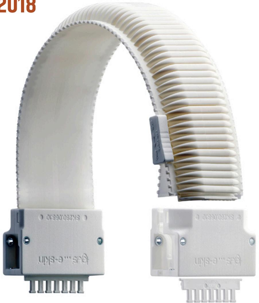
Die e-skin® ist ein aus Ober- und Unterschale bestehender Schlauch, der zusammengesteckt vollständig geschlossen ist. Sie besteht aus dem eigens hierfür entwickelten Polymerwerkstoff igumid SK. Durch den einfachen und wieder-verschließbaren Öffnungsmechanismus ist eine unkomplizierte Wartung und Inspektion der eingesetzten Leitungen möglich. (Quelle: igus®, Foto: klaus\_fritsche\_koeln)
