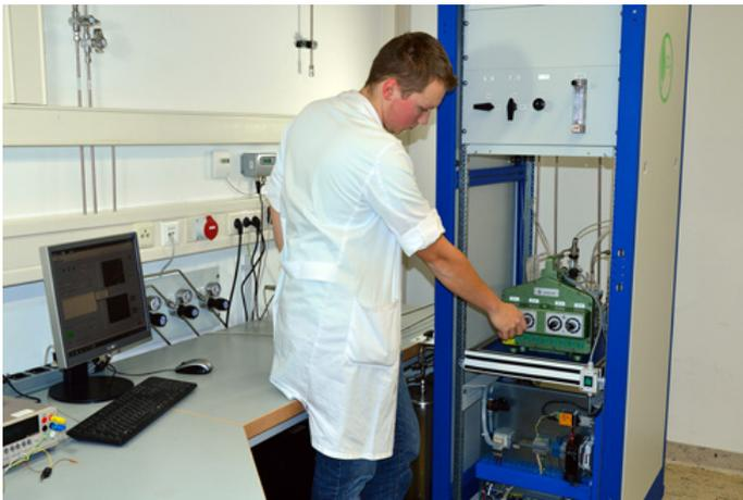
Abbildung 1: Akkreditierte CO<sub>2</sub>-Kalibrierung im E+E Kalibrierlabor. (Foto: E+E Elektronik Ges.m.b.H.)
