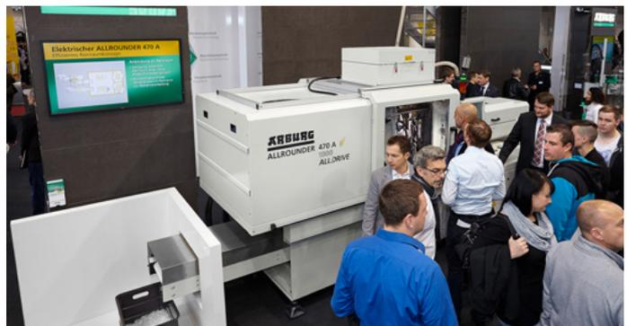
Der Allrounder 470 A in Reinraumausführung verfügt z. B. über ein Reinluftmodul mit Ionisierung über der Schließeinheit und ein verlängertes Förderband mit Tunneleinhausung zur Andockung an einen Reinraum. (Foto: ARBURG)
