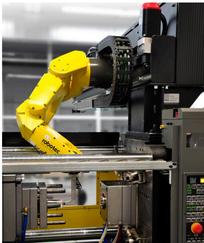
Die von einem Fanuc-Servomotor angetriebene Verfahrachse verleiht dem Roboter ein Plus an Reichweite. (Foto: Robotec Solution)
