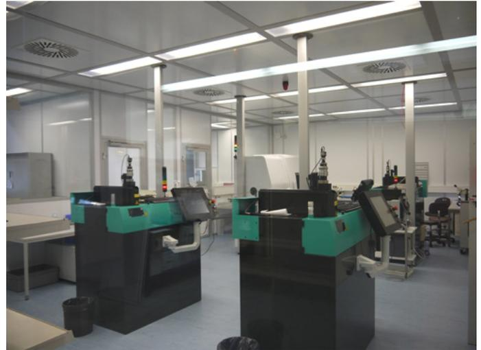
Ein weiterer Reinraum der ISO-Reinraumklasse 8 mit Laserschneidanlagen für die präzise Bearbeitung von Edelstahlrohren zur Herstellung von Stents.
