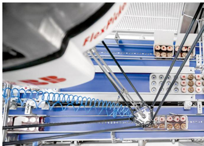
Deltaroboter wie der legendäre ABB FlexPicker haben sich sowohl in der Sekundär- wie in der Primärverpackung von Lebensmittel hervorragend bewährt. (Foto: ABB)
