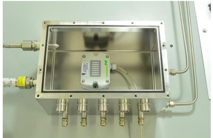
Abbildung 2: Zur Kalibrierung befinden sich die Messgeräte in einer Messkammer mit exakt definierter Gaskonzentration. (Foto: E+E Elektronik Ges.m.b.H.)
