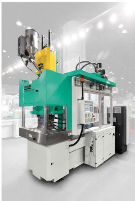
Ein vertikaler, vollautomatisierter Allrounder 375 V fertigt auf der Plastec West 2019 Radiuslehren. Ein platzsparend auf der Maschine platzierter Multilift Select übernimmt die Handhabung. (Foto: ARBURG)
