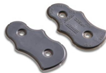
Metalleinleger werden auf zwei Werkzeugstationen eines vertikalen Allrounders 375 V in einer Zykluszeit von rund 45 Sekunden mit Kunststoff zu Radiuslehren umspritzt. (Foto: ARBURG)
