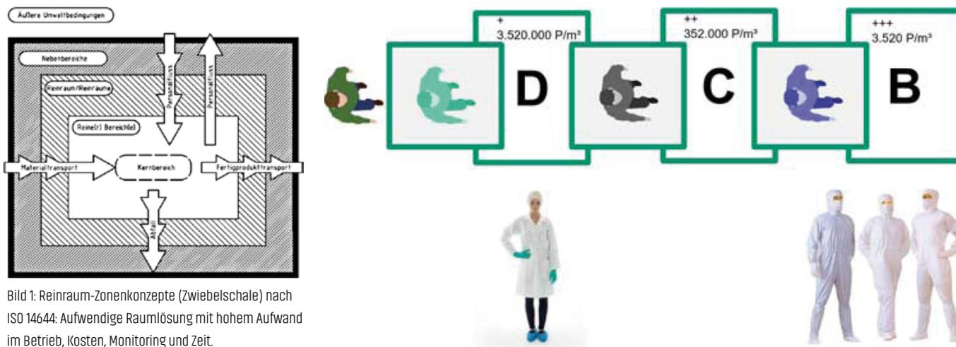
Bild 1: Reinraum-Zonenkonzepte (Zwiebelschale) nach ISO 14644: Aufwendige Raumlösung mit hohem Aufwand im Betrieb, Kosten, Monitoring und Zeit.
