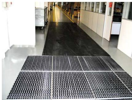
Nicht alle Klebematten eignen sich für den Flurförderzeug-Einsatz. Das patentierte Bürstenprodukt Profilgate dagegen schon (im Bild vorn). (Foto: Heute Maschinenfabrik)
