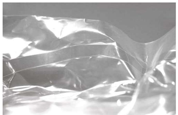
Abb. 3: Eine bedeutsame Barriere stellt die Versiegelung da. Daher wird innerhalb der Verpackungsvalidierung nicht nur der Versiegelungsprozess, sondern auch die Integrität der Versiegelung überprüft. (Quelle: Pfennig Reinigungstechnik GmbH)
