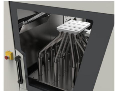
Kompakt integriert: Der Rohrverteiler findet innerhalb der Maschinenschutzverkleidung Platz. Alle produktberührenden Teile bestehen aus Edelstahl. (Bild: Engel)
