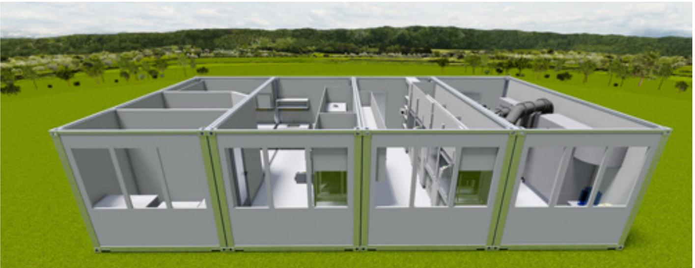
Idealisierte Reinraumanlage mit 4 Containereinheiten; © MK Versuchsanlagen
