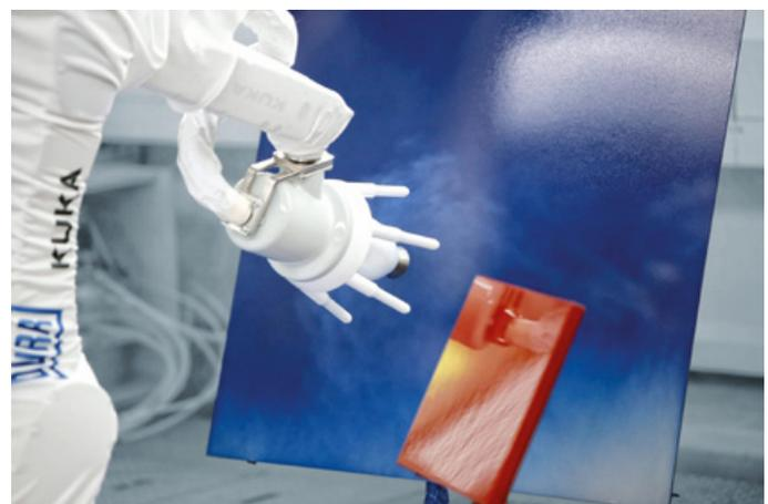
Der mit modernster, auf die Anwendung abgestimmter Applikationstechnik lackierfertig ausgestattete Kleinroboter wurde speziell für den automatisierten Lackauftrag in der allgemeinen Industrie entwickelt. (Bildquelle: Dürr Systems AG)
