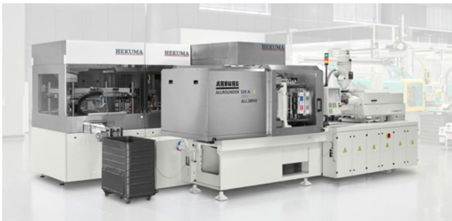
Der elektrische Allrounder 520 A mit Edelstahl-Schließereinheit erfüllt die hohen Qualitätsanforderungen bei der Produktion medizintechnischer Teile. (Foto: Arburg)
