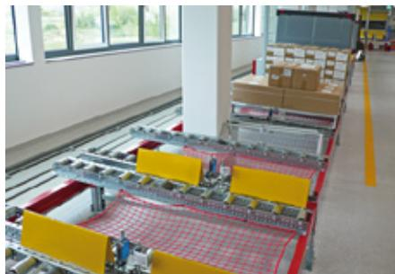
Die Konfektionierlinien sind mit drei Bahnhöfen ausgestattet, von denen jeder aus sechs Puffer- bzw. Abgabepunkten besteht, die als Gefällrollenbahnen ausgeführt sind. (Copyright Stöcklin Logistik AG)
