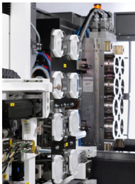
Dank barrierefreier Schließmechanik kann das Handling ohne Störkantenumfahrung direkt von der Seite aus ins Werkzeug gelangen. (Bild: Hekuma)
