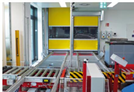
Die Schnellaufitore dienen als Klimaschleuse und verhindern, dass Unbefugte das Lager betreten können. (Copyright Stöcklin Logistik AG)
