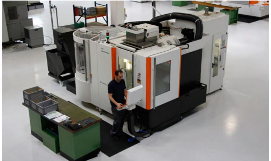
Die Mikron HPM 450U mit dem 10-fach WPC-Palettenwechsler und dem ATC Werkzeugmagazin mit 220 Werkzeugplätzen ist sehr kompakt ausgeführt und besticht laut Sistro durch ein ausgezeichnetes Preis-Leistungsverhältnis.
