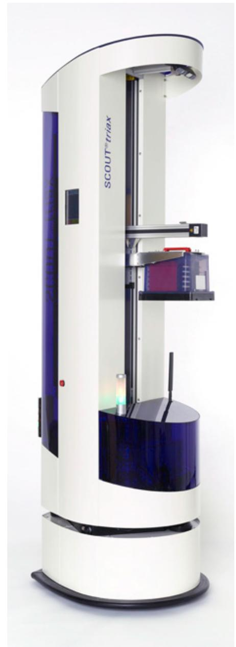
SCOUT triax® der Roth & Rau - Ortnr GmbH: Ausgestattet mit einem 3-Achs-System von RK Rose+Krieger eignet sich der Roboter besonders für das autonome Handling in unterschiedlichen Greifhöhen.
