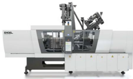
In nur einem Arbeitsschritt fertigt ENGEL auf der Messe Tropfkammern mit integriertem Filter. Die holmlose ENGEL e-victory combi Maschine verarbeitet drei verschiedene Rohmaterialien. (Bild: ENGEL)
