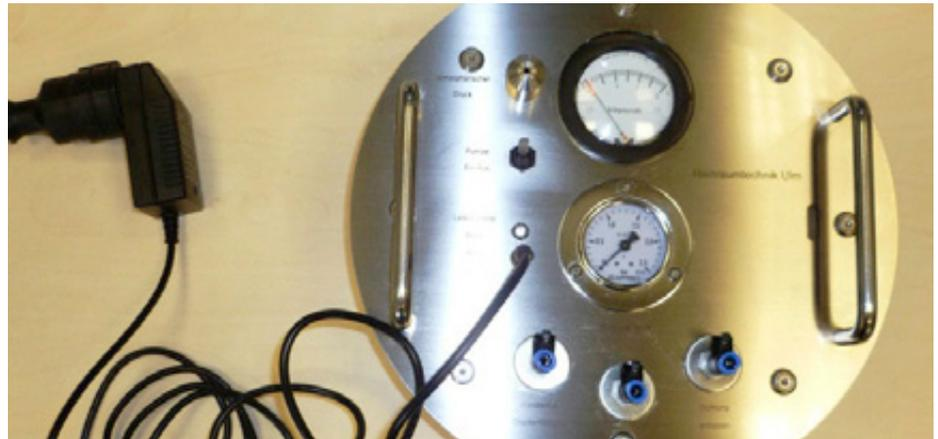
Es gibt verschiedene Prüfverfahren, um Leckagen in Handschuhen festzustellen; doch im Gegensatz zum oft verwendeten Blasen-test (Bubble Test), der Leitfähigkeitsmessung (Conductivity Test) und dem Sauerstofftest (Oxygen Test) wird beim hier verwendeten Druckabfalltest das gesamte Handschuh-system getestet.
