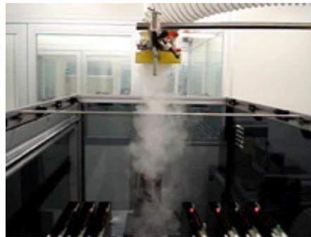
Hamilton Microlab Star im ISO 1 Reinraum des Fraunhofer IPA während einer Strömungsvisualisierung. Bildquelle: Fraunhofer IPA
