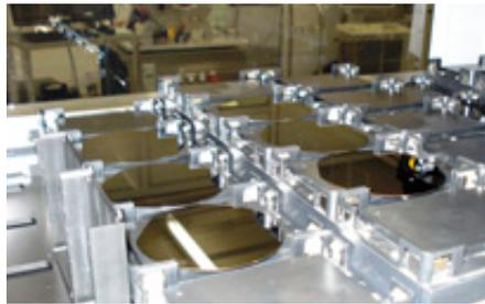
Ausgelegte Silizium-Wafer zur Messung sedimentierter Partikel in einem Hamilton Microlab Star. Bildquelle: Fraunhofer IPA
