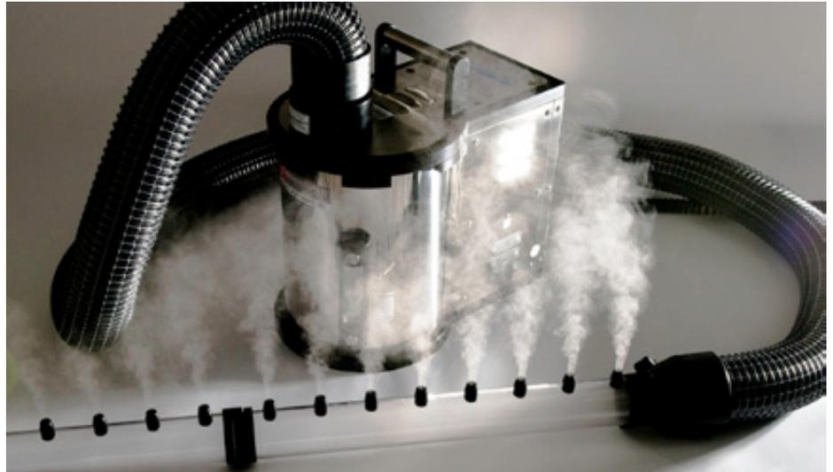
am Generatorschlauch montierte Drosselklappe individuell regelbar ist. „Verbrennungen“, wie sie bei Kontakt mit flüssigem Stickstoff durchaus vorkommen können, gibt es beim DI-Wassernebelgenerator nicht. Zugleich wiegt das kompakte Gerät nur einen Bruchteil eines Stickstoff-Nebblers und ist somit auch im Handling sehr viel flexibler.
