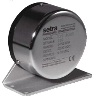
04.01.2013 | Der Differenzdruck-Messumformer D239 von SETRA bietet eine exzellente Linearität von besser 0,1% des Endwertes. Er wird mit Messbereichen zwischen  $\pm 60$  Pa und 70 kPa angeboten. Dieser äußerst robuste, kapazitive Sensor verfügt über eine hohe Überlastsicherheit und ist für Systemdrücke bis zu 17 bar geeignet. Der Betriebstemperaturbereich ist von  $-18^{\circ}\text{C}$  bis  $80^{\circ}\text{C}$  spezifiziert.
