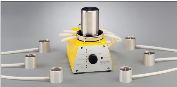
Aerosol-Verteil- und Verdünnungssystem mit seinen 6 Ausströmern, die über 3 m langen Silikonschlauch mit den Ausgangsports verbunden sind
