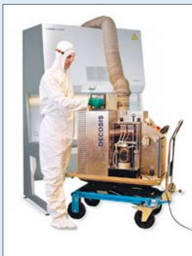
Abb. 4 H 2 O 2 Begasung einer BERNER FlowSafe® Sicherheitswerkbank.
