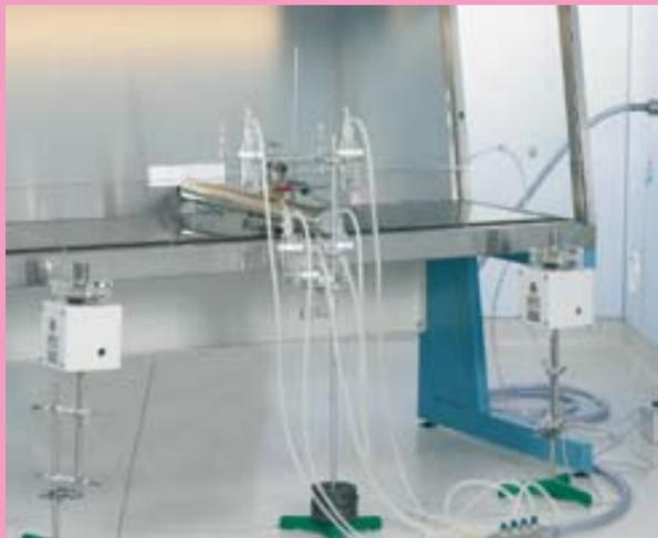
**Abb. 2** Teststand mikrobiologische Prüfung des Personenschutzes.
