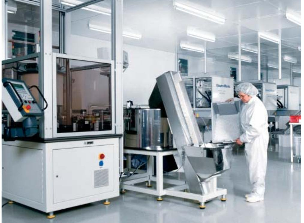
Maschinenposition im Reinraum fixiert. Schließeinheiten tauchen zur Produktion freitragend in den Reinraum ein; Braun (Bahlingen, D)
