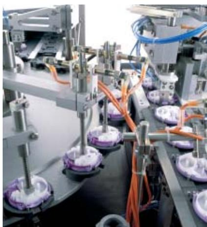
Automatische Montagestation für Pulver-Inhalatoren bei Risdon Pharma
