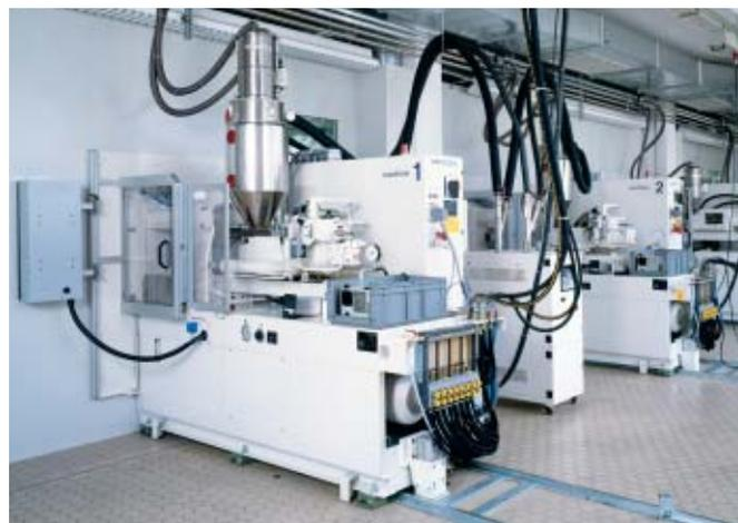
*Produktionsstellung der Maschine: Schließeinheit in den Reinraum eingefahren*
