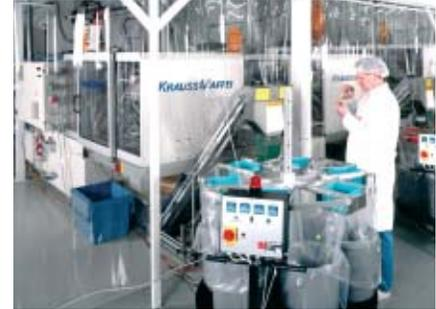
Trennung der Produktion (Überdruckraum) mit Folienvorhang; Frör (Erlangen, D)
