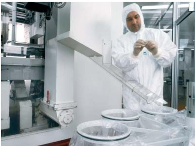
*Spritzgießmaschine seitlich an einen Reinraum angebunden, Formteil-
