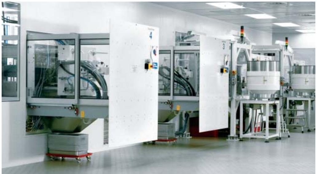
Schließeinheiten der C-Baureihe ragen freitragend in den Reinraum
