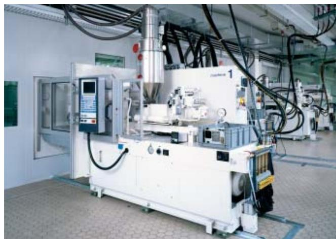
*Stellung für Reinigung, Maschinenwartung, Werkzeugwechsel etc.: Schließeinheit aus dem Reinraum ausgefahren; West Pharmaceutical Services (Stolberg, D)*
