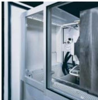
Oben: Energieführungen in der Schließeinheit, Verkleidungsblech als Schottblech mit Energieanschlüssen
