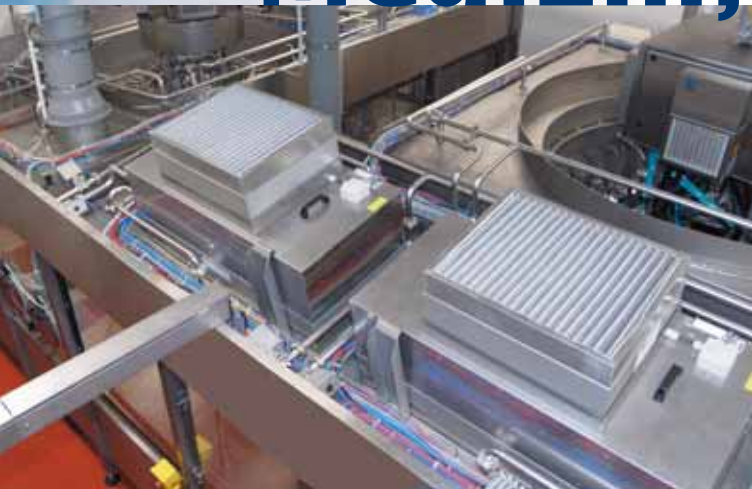
Zuluft- und Abluftsystem an einer Aseptik-Abfüllmaschine in der Getränkeindustrie
