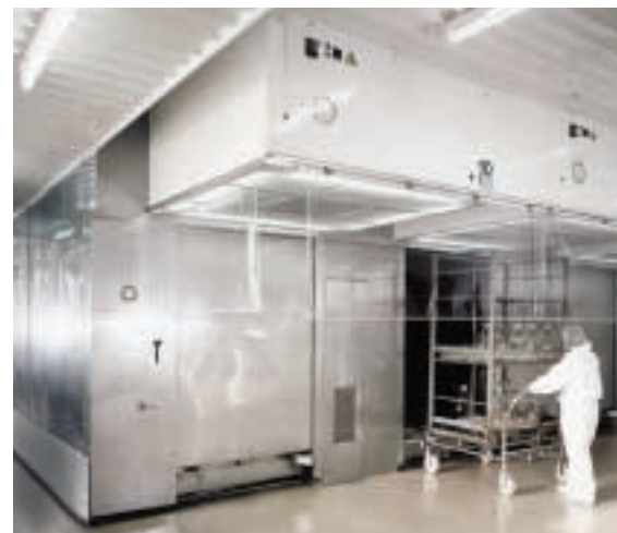
Heissluftsterilisation, geringer Wartungsaufwand, keine Gefährdung durch Kreuzkontamination
