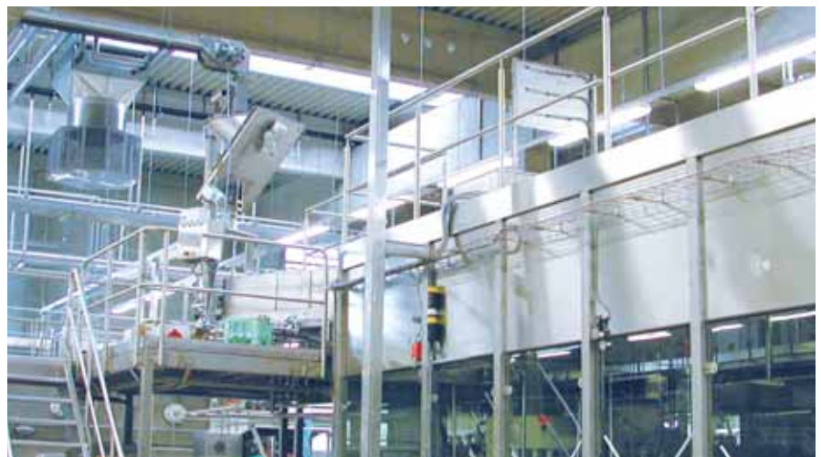
ULTRACLEAN®-Reinraumeinhausung für Abfüllmaschinen in Produktionshallen
